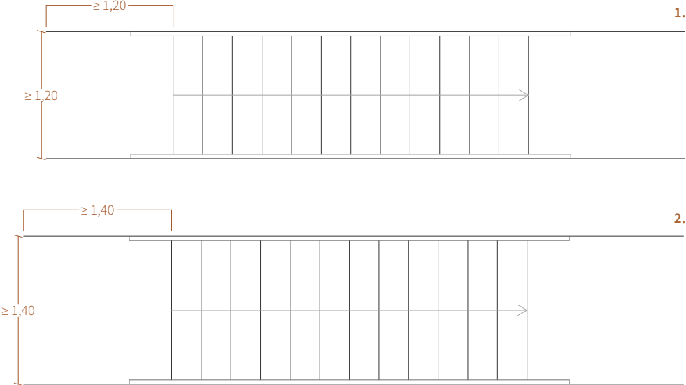
Fig. 73 1. Planta da escada em habitação para mais do que uma família com menos de 28 metros 2. Planta da escada em habitação para mais do que uma família com mais de 28 metros
