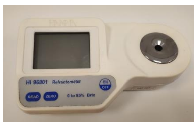
Figura 6. Instrumento utilizado na medição do teor de sólidos solúveis.
