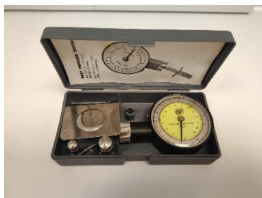
Figura 8. Instrumento utilizado na medição da dureza.
