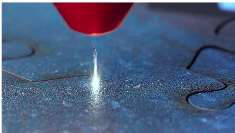
Figuras 64- Processo de corte a laser. (Trotec Laser, n.d.)
