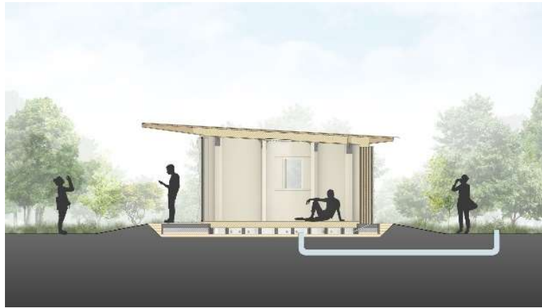
Imagem 50 - Corte (Tubagem para ventilação) [41].
