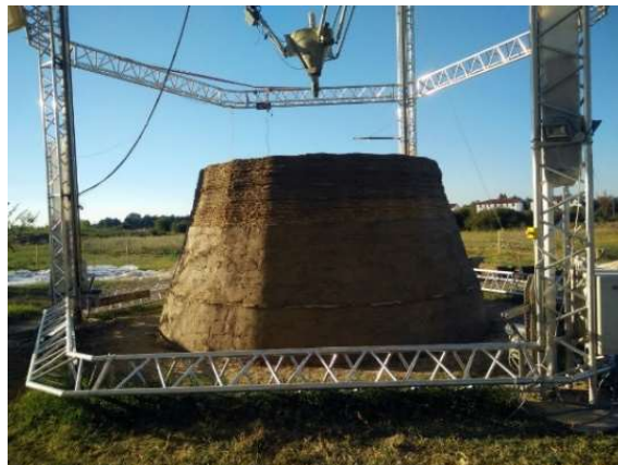
Imagem 32 - Extrusor da impressora Delta Big WASP [41].
