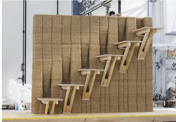
Imagem 21 - Parte de parede impressa com escada embecida fabricada pela empresa IAAC e WASP [31] e [32]
