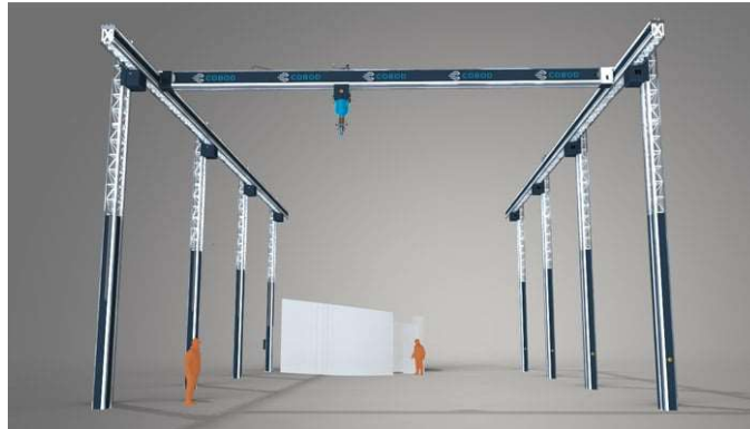
Imagem 29 - Sistema de pórtico (gantry) da empresa COBOD [40].
