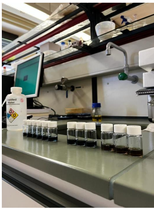
Figura 40. Determinação da quantidade de BSA utilizando o teste de Bradford.
