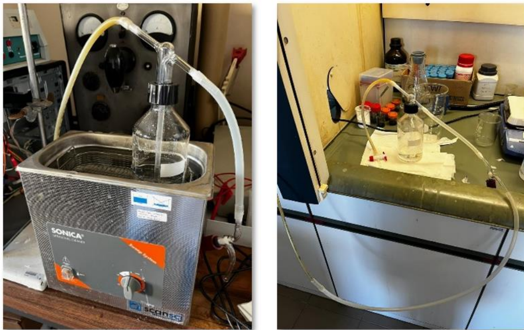
Figura 17. Solução de polimerização, com sistema de vácuo e colocada em ultrassons; Solução de polimerização borbulhada com N_2
