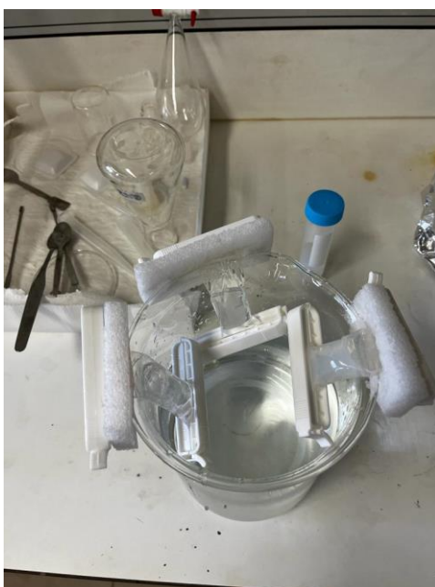
Figura 12. Membranas de diálise contendo a solução de nanoMIPs para remoção da molécula molde.
