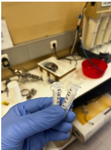
Figura 25. Tubos Amicon com cut-off de 30 kDa utilizados para purificação das amostras.
