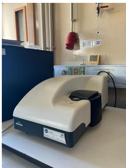
Figura 21. Equipamento utilizado, Malvern Zetasizer Nano ZS, da Malvern e cuvetes utilizadas para medição de tamanho e do potencial zeta (DTS0012 e DTS1070, respetivamente.)
