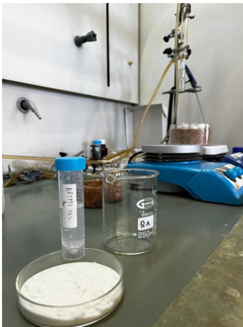
Figura 15. Esferas de vidro antes da silanização com solução aquosa de APTMS 15%.
