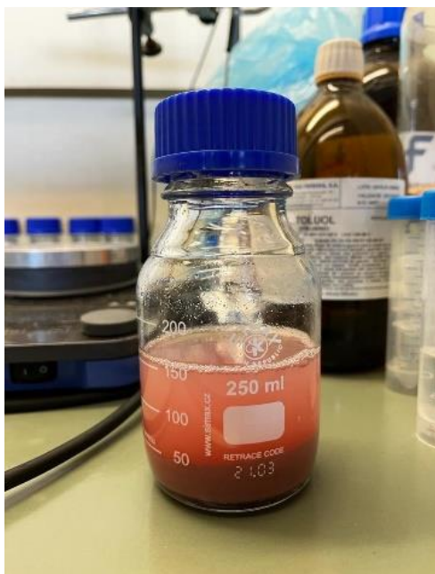
Figura 19. Esferas de vidro imersas na mistura de polimerização
