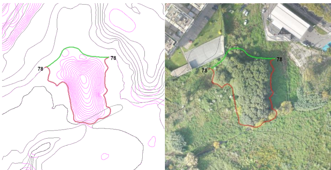
Figura 47 – Reconstrução manual das curvas de nível
