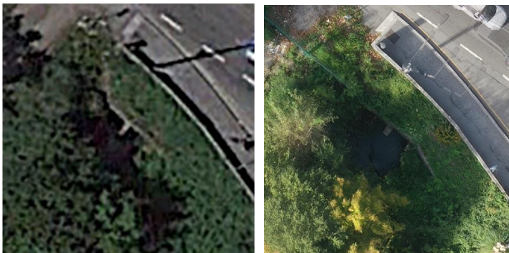
Figura 42 – Comparação entre a imagem mais recente do Google Earth (2021) com o ortofotomapa gerado via PIX4Dmapper
