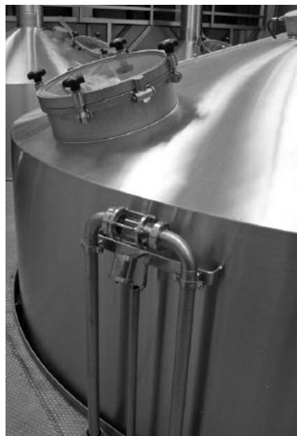
Figura 5. Cuba-filtro da empresa Victory Brewing (Barth,2013).
