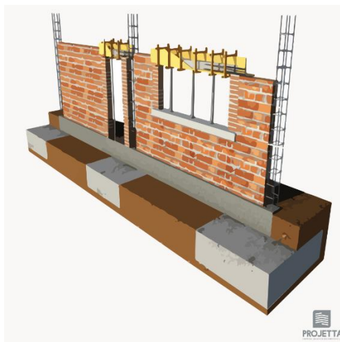
Figura 72 Fechamentos em Alvenaria - Fonte: Projetta
