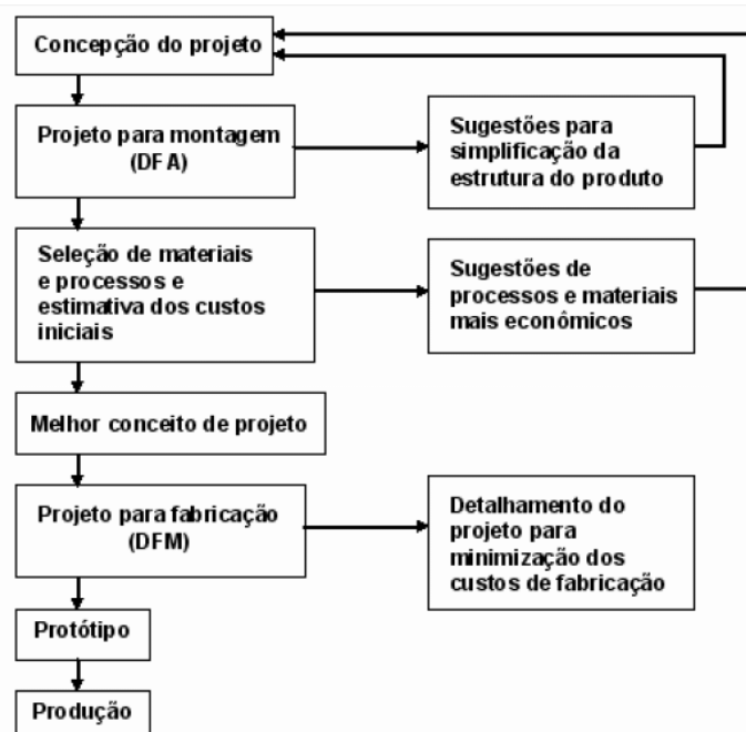
Figura 12 Etapas Típicas Realizadas Em Um Estudo DFMA Usando O DFMA. - Fonte: Boothroyd 1994
