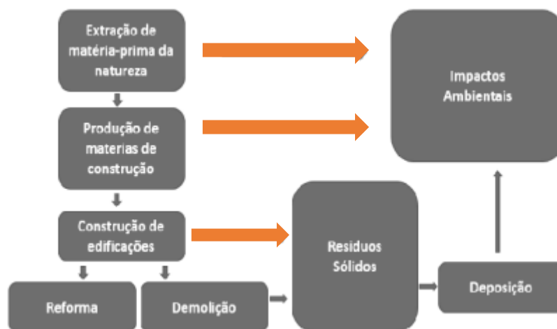
Figura 13 Cadeia Produtiva Dos Materiais Da Construção Civil. Fonte: Gasquez, 2015 Adaptado Pelo Autor
