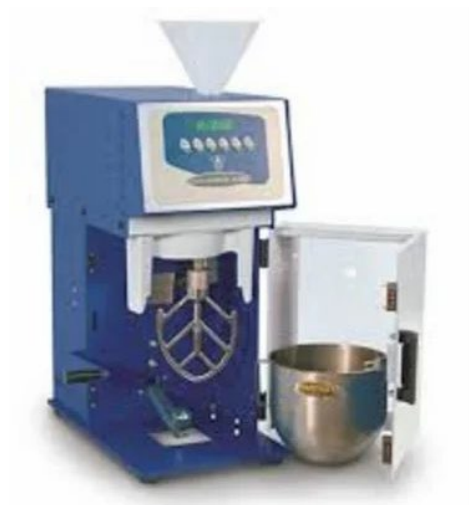
Figura 27 – Processo de Amassadura no Mortar Mixer
