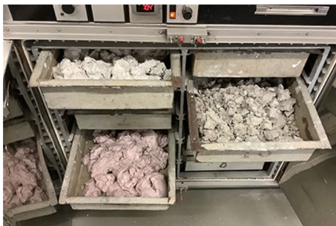
Figura 18 – Resíduo de Mármore em estufa a 100 \pm 2 C° até obter massa constante
