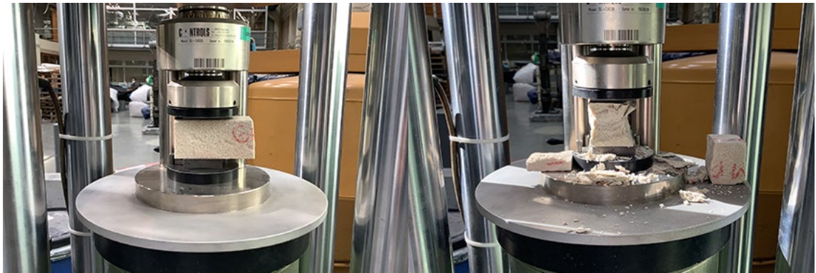
Figura 34 – Ensaio à compressão de um provete de GMP.
