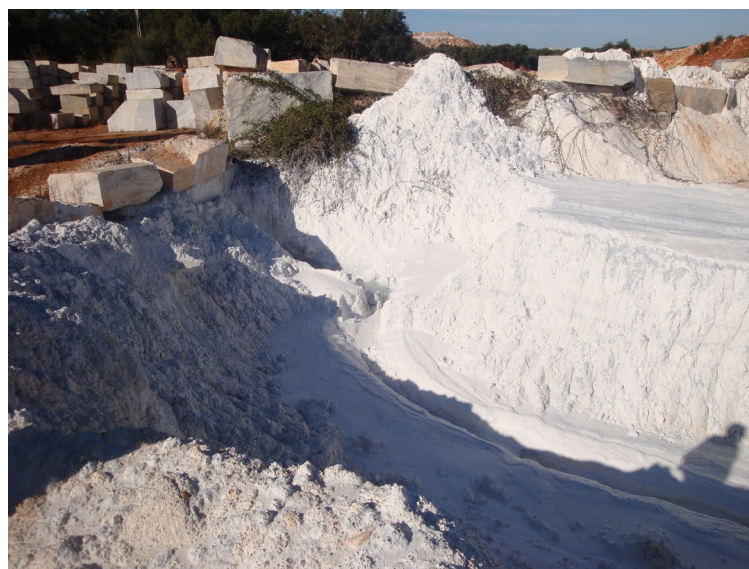
Figura 2 – Acumulação de lama de mármore junto das pedreiras no Alentejo (Portugal).
