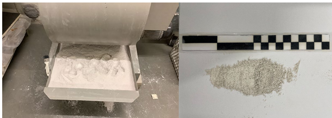
Figura 22 – Resultado do processo de moagem no Los Angeles – Pó de mármore
