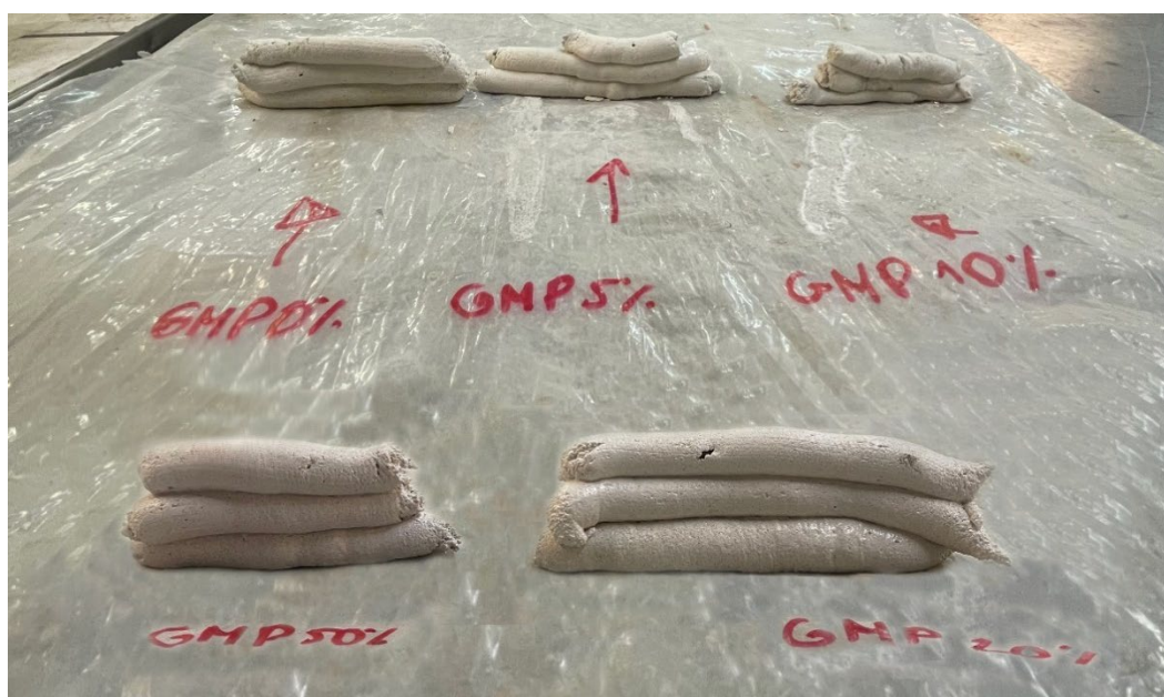
Figura 30 – Testes de extrusão manual das argamassas GMP0%, GMP5%, GMP10%, GMP20% e GMP50%
