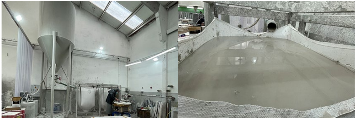
Figura 16 – 3º Tanque a despejar o pó de mármore filtrado e BigBag cheio a secar, respetivamente.
