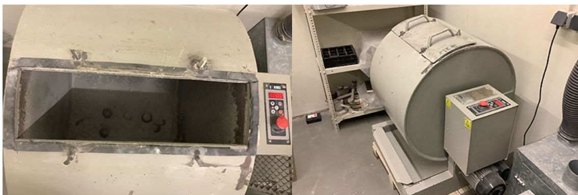
Figura 21 – Moagem na máquina de Los Angeles durante 30 minutos
