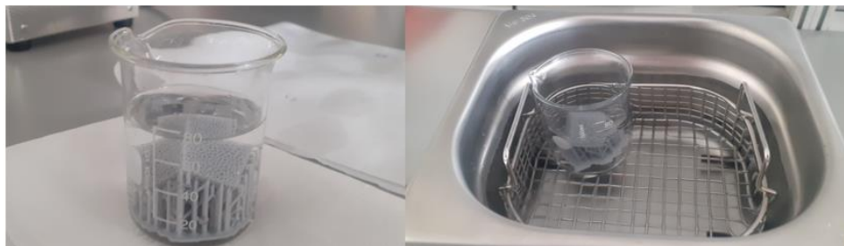
Figura 106 Lavagem das amostras por ultrassons na tina Soltec 1200 M S3 num recipiente com concentração de 96% de álcool isopropílico.
