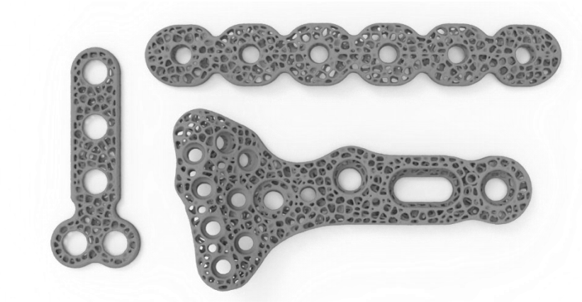
Figura 152 Modelos 3D extraídos da internet de placas ortopédicas convertidos em porosos tendo um cubo Estocástico Voronoi 3D Dendro 4000 pontos 0,4 de espessura como base.
