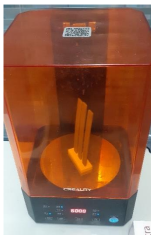
Figura 61 Pós-cura dos provetes utilizando o suporte.
