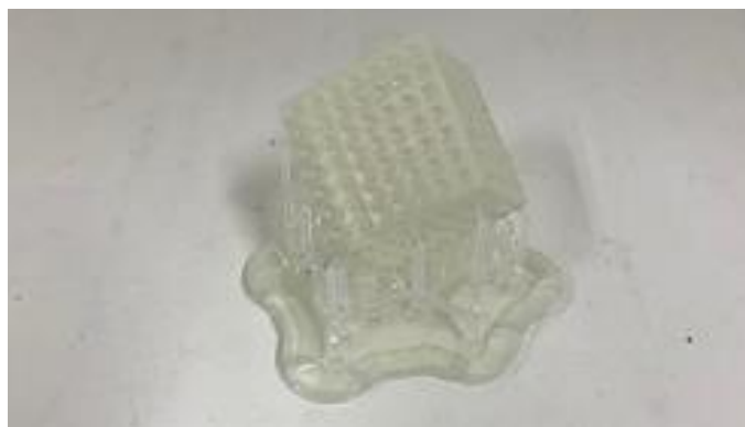
Figura 104 Amostra impressa em resina Formlabs Clear V4 com poros preenchidos.
