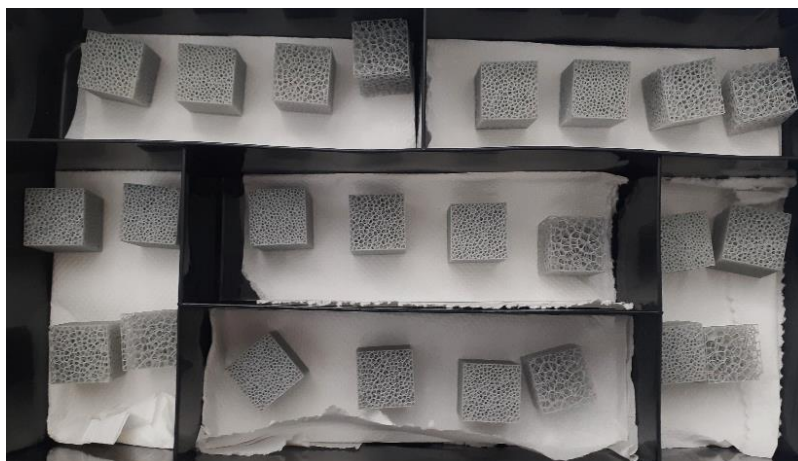
Figura 108 Amostras porosas após remoção dos suportes.
