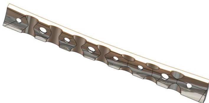
Figura 157 Placa LC-DCP modelada com rasgos na superfície de contacto com o osso.
