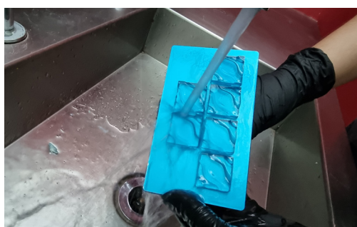
[figura 57] Fabrico dos módulos com recurso a duas impressoras 3D SLA (Cortesia de Cristina Ferreira).
