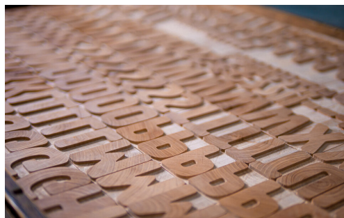
[figura 22] Uso de uma fresadora CNC para a realização da Hamilton Artz, design por Erik Spiekermann.
