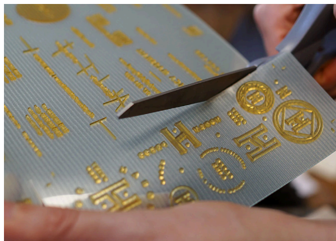
[figura 13] Placa de fotopolímero para impressão.
