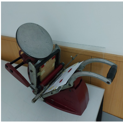
[figura 102] Adana com os módulos impressos em 3D para a impressão a seco.
