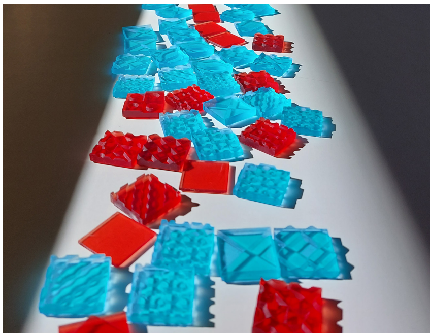
[figura 60] Peças finais de resina impressas em 3D (SLA). Módulos das famílias A a D e espaços.
