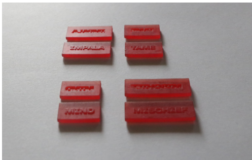
[figura 103] Cunho e contracunho dos módulos impressos em 3D para a impressão a seco.
