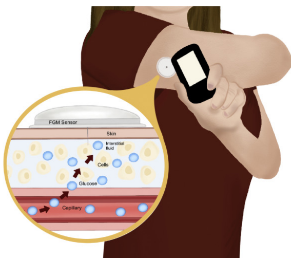
Figura 1 - Uma ilustração simples do mecanismo da Monitorização da Glicose Intersticial[7]
