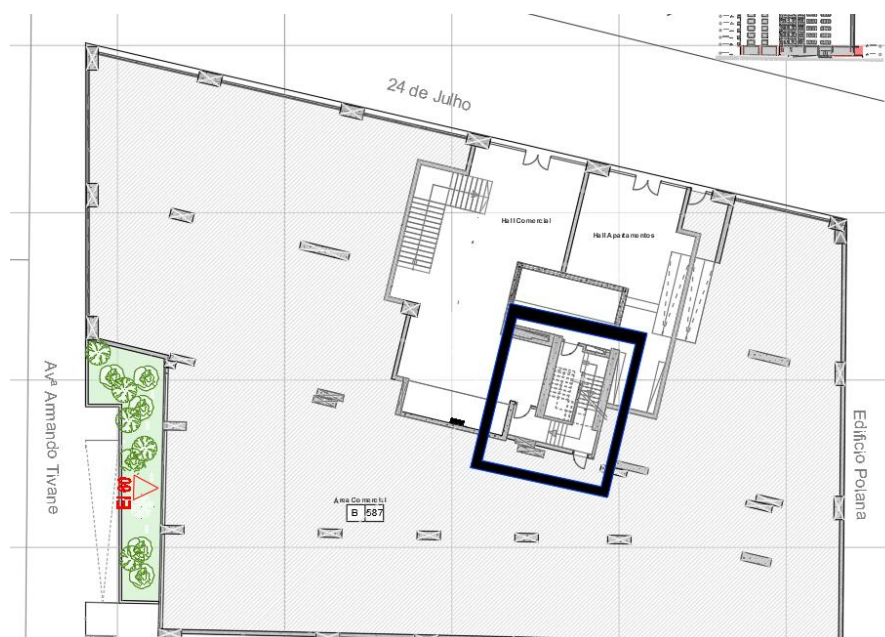
Figura 6.10- Quebra de continuidade na V.V.E. A (Piso 0)
