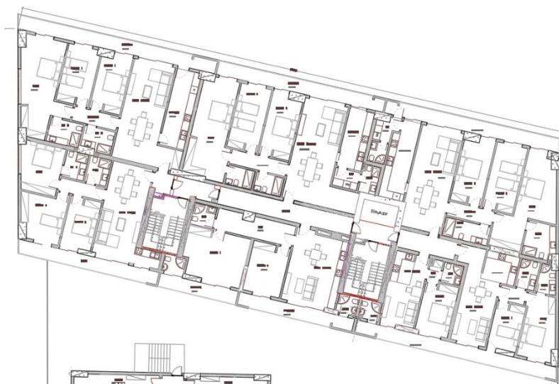
Figura 6.13- Adição de CCF nos pisos do corpo A (Piso 1)
