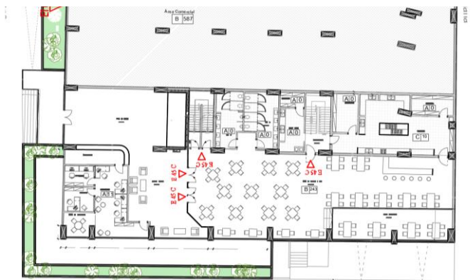
Figura 5.1 – Vãos entre a UT III (administrativos) e VII (restaurante)
