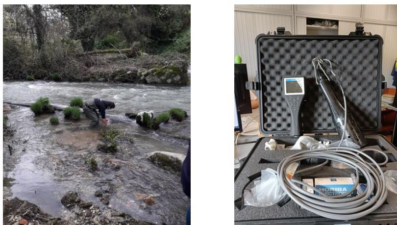
Figura 15 - Amostragem de uma amostra de água; Sonda multiparamétrica Horiba, modelo U-51.
