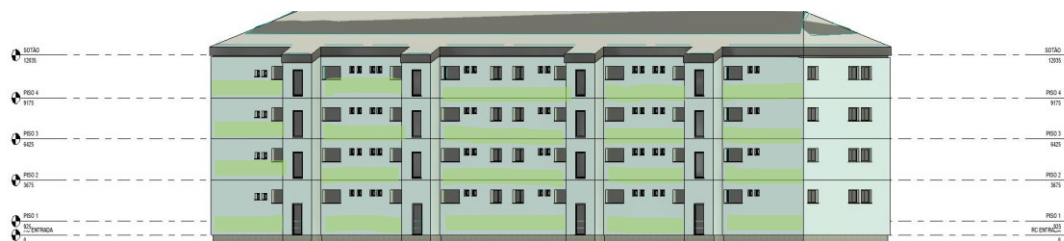
Fig. 35 - Revestimento da fachada com painéis
