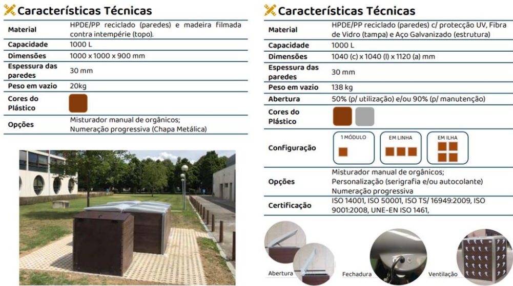
Figura 4.7: Características técnicas da caixa estruturante e compostor modular Vermican. Fonte: Lipor.
