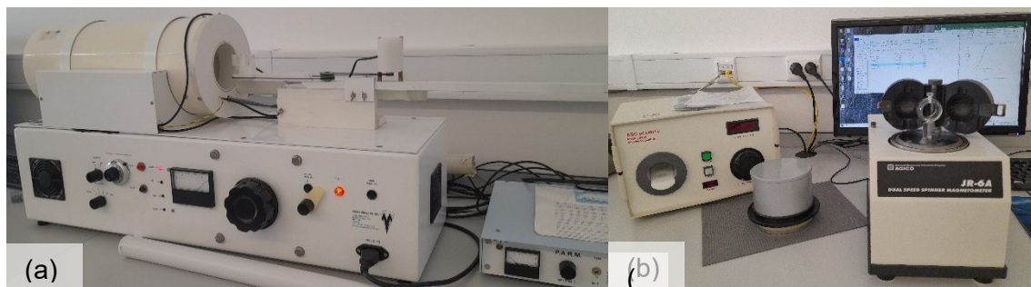
Figura 37 – (a) Desmagnetizador em campo alternado (Molspin); (b) À esquerda o magnetizador de campo forte (IM-10, ASC Scientific) e à direita o magnetómetro JR-6 Spinner da AGICO.
