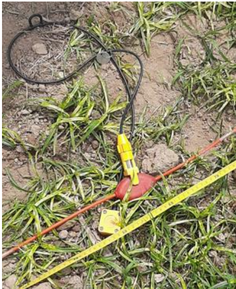
Figura 1 - Geofone conectado através de cabos a um sistema de aquisição de dados fora da foto.
