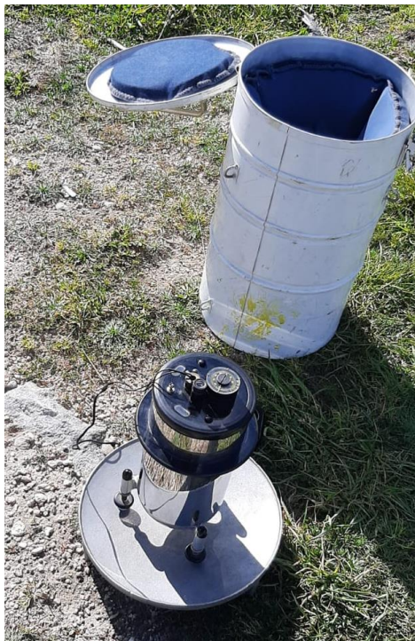
Figura 25 – Gravímetro the Pioneer , Worden nº679, model 155, caixa própria para transporte e o respetivo prato côncavo.
