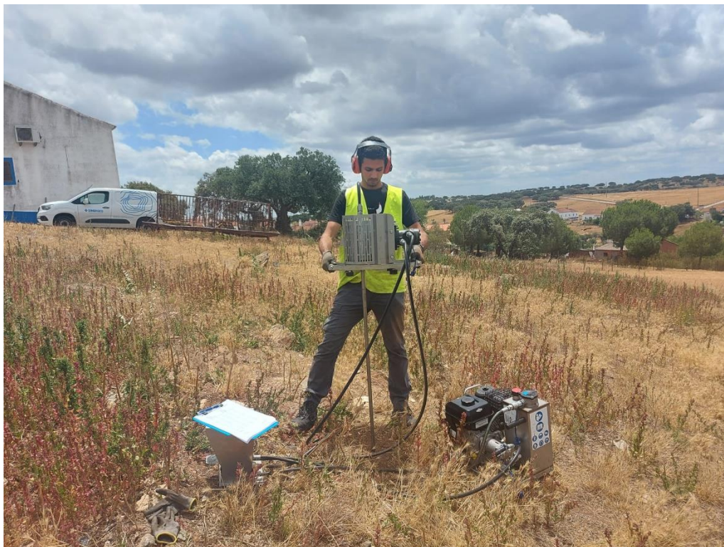
Figura 5 - Realização de um ensaio DPL.
