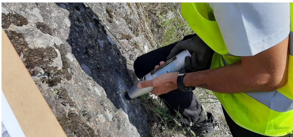
Figura 7 - Utilização do martelo de Schmidt no talude estudado.
