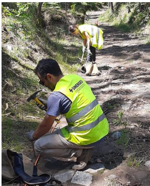
Figura 9 - Colocação dos elétrodos e extensão do cabo elétrico.
