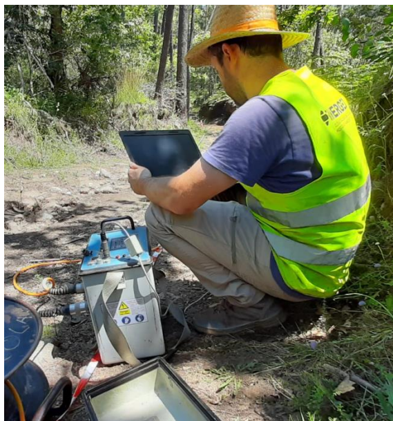
Figura 10 - Resistímetro ligado ao cabo elétrico e a um computador de campo.
