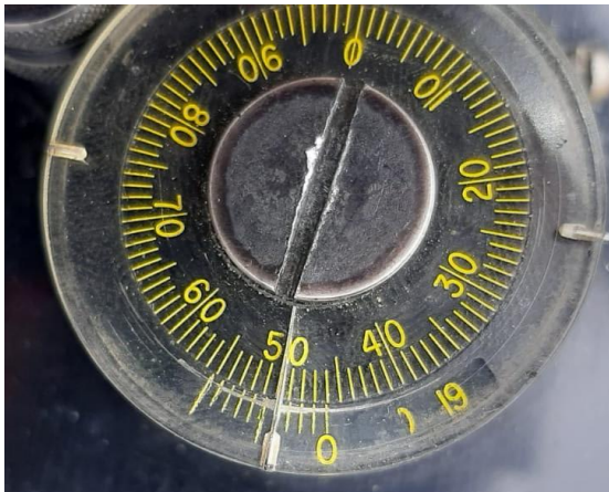
Figura 27 -Leitura do valor através do parafuso do gravímetro.
