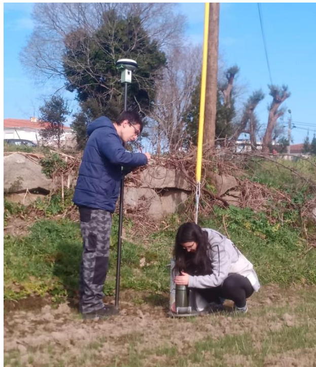
Figura 26 – Utilizador a fazer medições no gravímetro e a tirar as coordenadas de um ponto no GPS.
