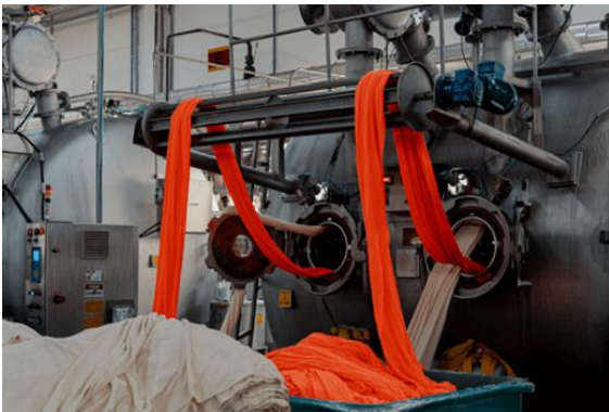
Figura 5. Tingimento de estruturas têxteis em corda (A) e em aberto (B) (Cores&Tons, 2022; JH, 2023).
