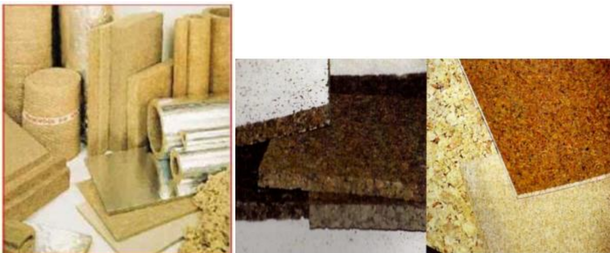
Figura 2.15 e 2.16- Lã de Rocha (esq.) e aglomerados de cortiça (dir.) [10]
