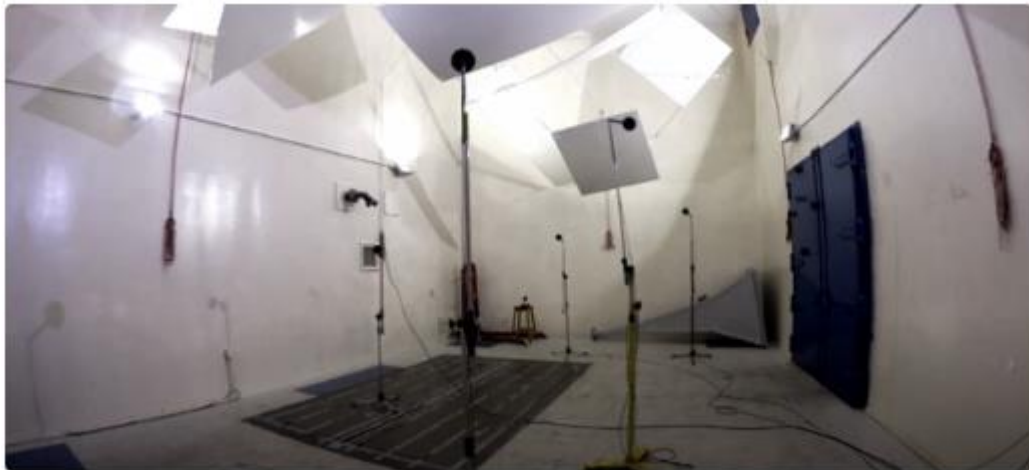
Figura 2.14- Fotografia de uma câmara de reverberação [9]
