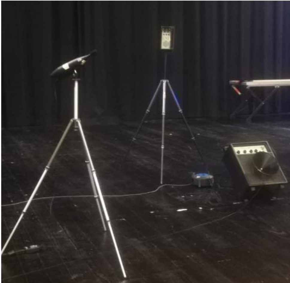
Figura 4.12- Equipamento de emissão de fonte sonora, de RASTI e sonómetro (foto do autor)
