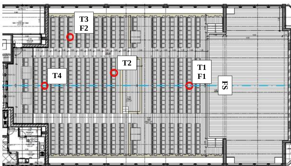
Figura 4.13- Pontos de medição de tempo de reverberação (Ti) e de ruído de fundo com e sem AVAC (Fi) [28]
