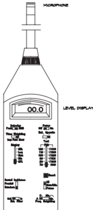
Figura 2.4- Representação ilustrativa de um sonómetro [5]
