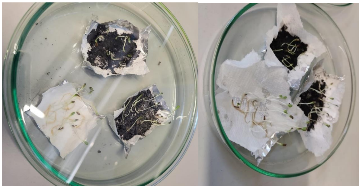
Figura 11. Evolução do ensaio de germinação de sementes de alface nos dias 1 (canto esquerdo superior), 4 (canto direito superior), 8 (canto esquerdo inferior) e 10 (canto direito inferior), respectivamente
