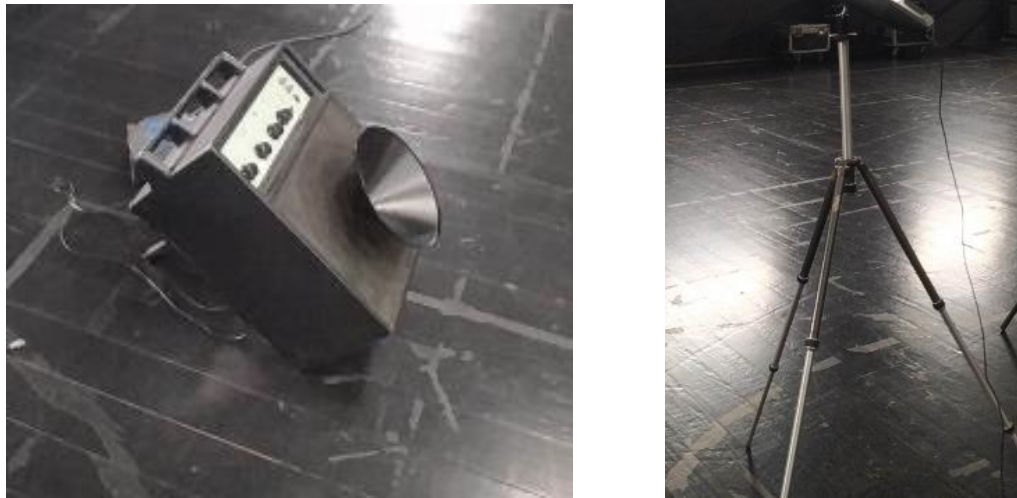
Fig. 4.9. – Fonte sonora Brüel & Kjaer, modelo 4224, inclinada 45°, à esquerda e Sonómetro Brüel & Kjaer, modelo 2260, à direita. [foto do autor]
