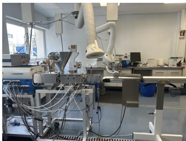
Figura 20 – Fotografia da montagem utilizada para os ensaios de reologia com o SDV (CIRES Lda.)
