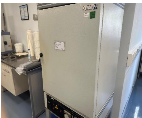
Figura 21 – Fotografia da estufa utilizada para os ensaios de estabilidade estática (CIRES Lda.)
