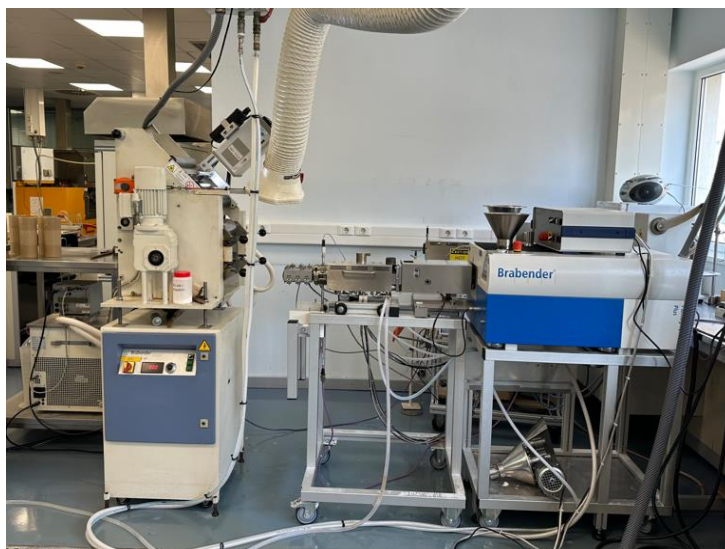
Figura 18 - Fotografia da montagem utilizada para a extrusão de filmes e sua análise no FQA (CIRES, Lda.)
