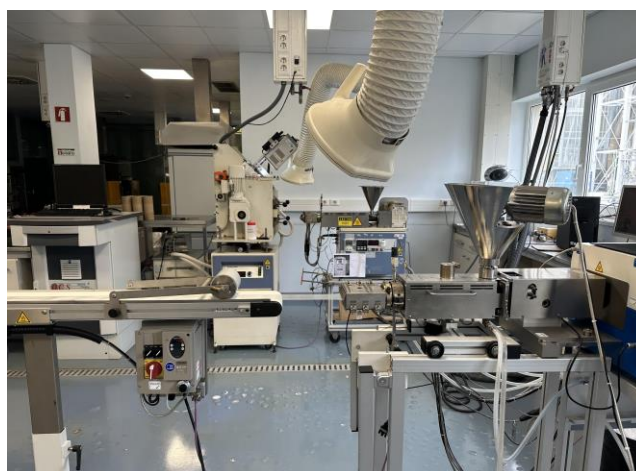
Figura 17 – Fotografia da montagem utilizada para a extrusão de filmes (CIRES, Lda.)
