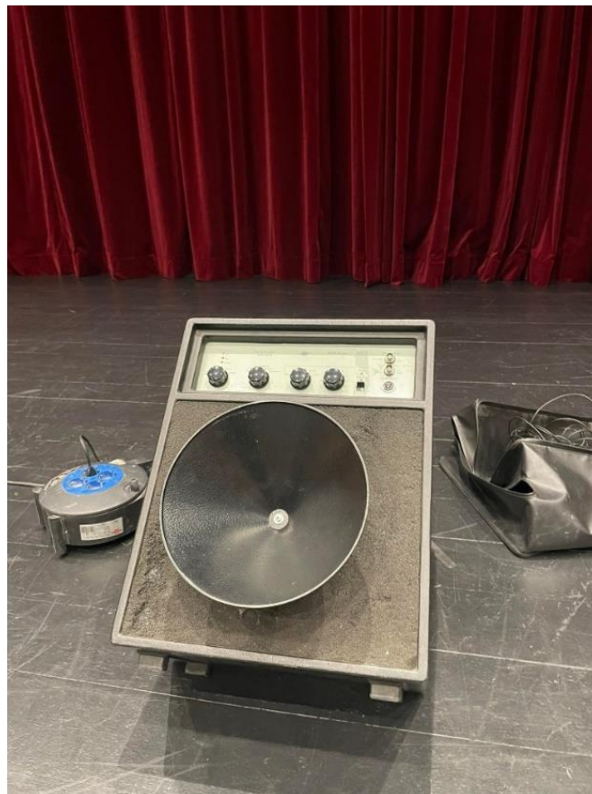
Figura 4.13 - Fonte sonora Brüel & Kjær, modelo 4224 (foto do autor)
