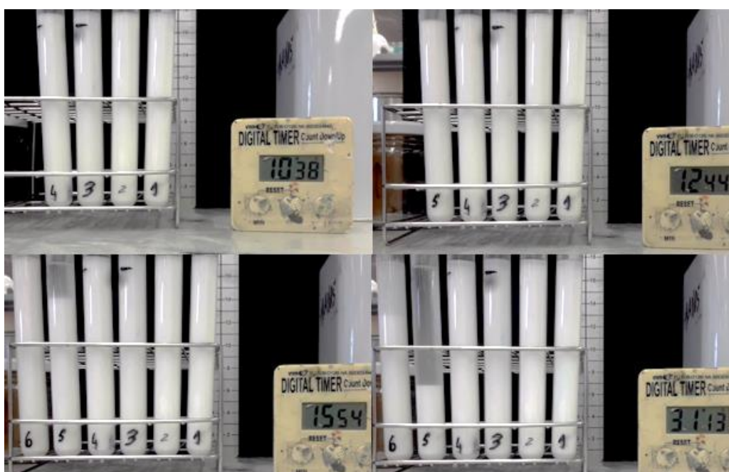
Figura 4.2. Capturas do registo videográfico realizadas na parte experimental II para as misturas dos solventes de 1 a 6 e o mesmo pigmento anticorrosivo (PA-0).
