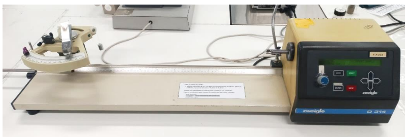
Figura 12. Fotografia do equipamento da Zweigle utilizado para os ensaios de torção.
