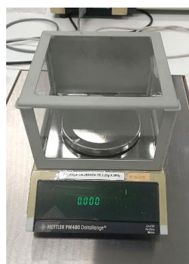
Figura 13. Fotografias dos equipamentos utilizados na determinação da gramagem da malha.
