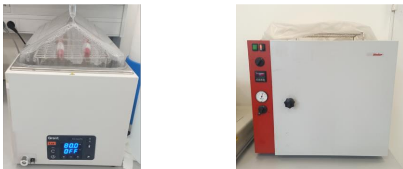
Figura 9. Fotografias dos equipamentos utilizados na vaporização dos fios: banho termostático, à esquerda, e estufa ventilada, à direita.
