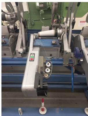
Figura 10. Fotografia do processo de bobinagem dos fios.
