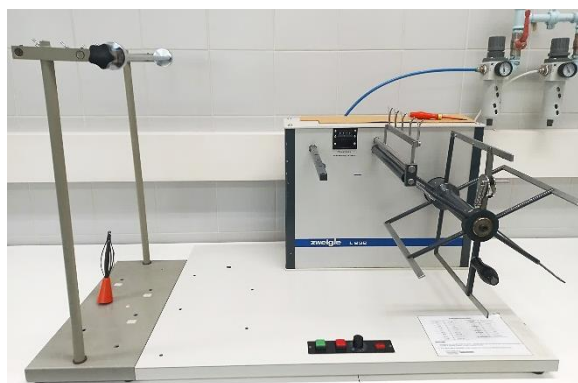
Figura 15. Jardeira utilizada nos ensaios de determinação do título dos fios.
