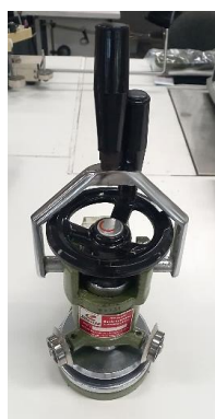
Figura 13. Fotografias dos equipamentos utilizados na determinação da gramagem da malha.
