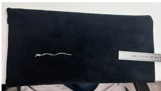
Figura 14. Fotografia de ensaio de determinação de comprimento por medição fibra a fibra.
