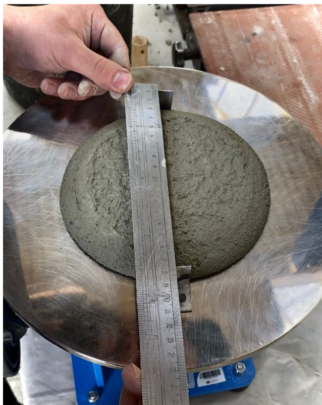
Figura 41 – Ensaio de Espalhamento.
