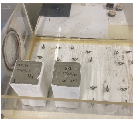
c) Disposição de provetes e de anilhas de suporte
