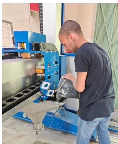
d) Colocar a mistura na impressora
