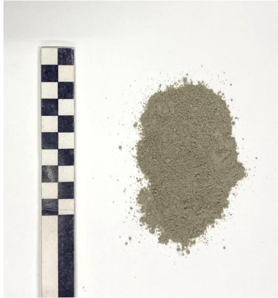
Figura 25 – Fotografia da argamassa comercial ensacada para Impressão 3D utilizada neste trabalho
