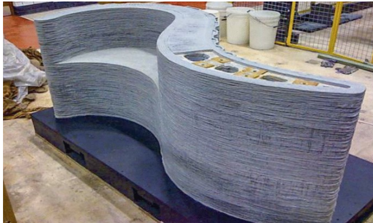
Figura 14 – Betão impresso com reforço e espaços vazios funcionais retirado de (Nematollahi, Xia, and Sanjayan 2017)
