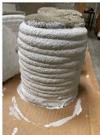
b) Provete Impermeabilizado
