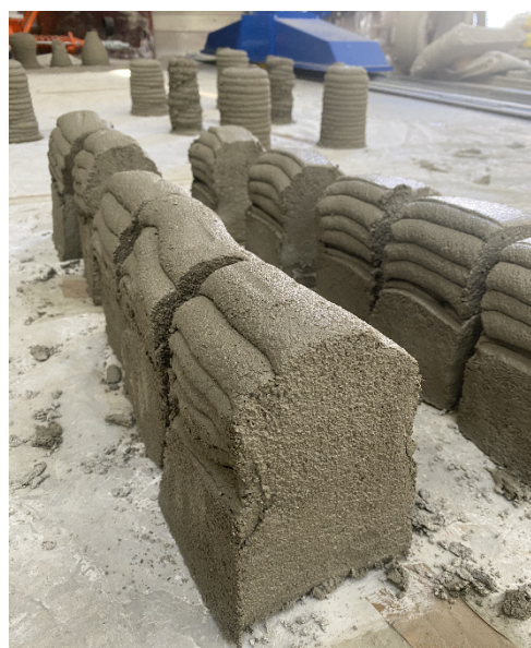
d) Provetes retangulares já cortados e com alguns ajustes no acabamento exterior
