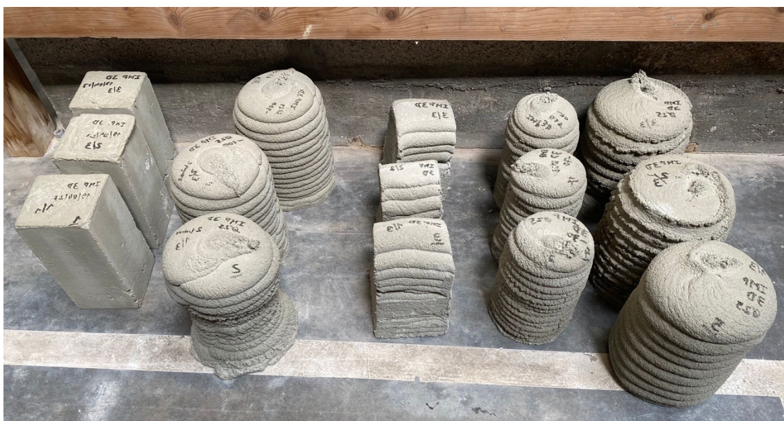
Figura 38 – Provetes utilizados para ensaios higrotérmicos
