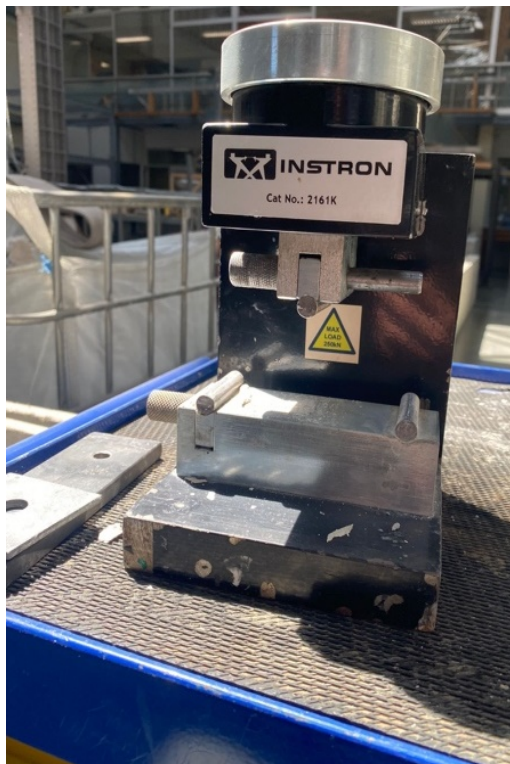
Suporte para ensaio a flexão
