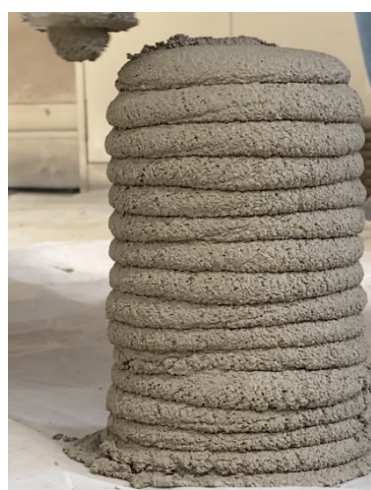
d) Provete cilíndrico finalizado (16 camadas)
