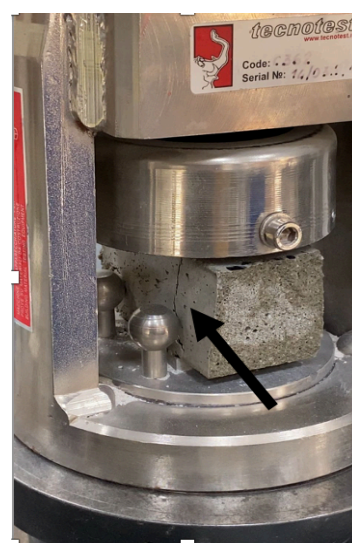
b) Rotura do provete
