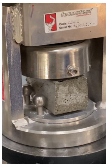
a) Provete na máquina de ensaio
