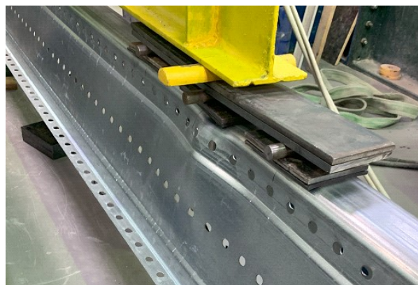
Figura 3.4 – Modos de Rotura dos Ensaios de Carga Descendente: a) Rotura do OMEGA 70x1.5, b) Rotura do OMEGA 170x2.0, c) Rotura do OMEGA 300x2.5
