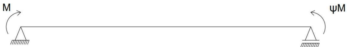
Figura 5.2 – Esquema seguido para os Casos de Aplicação de Carga
