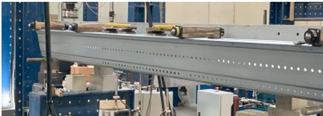
Figura 3.2 – Ensaio das Vigas no Layout de 4 metros: a) Desenho simplificado do layout , b) Fotografia durante o ensaio de aplicação de carga descendente no OMEGATEK 70, c) Fotografia da configuração dos travamentos para utilização na carga ascendente do OMEGATEK 170
