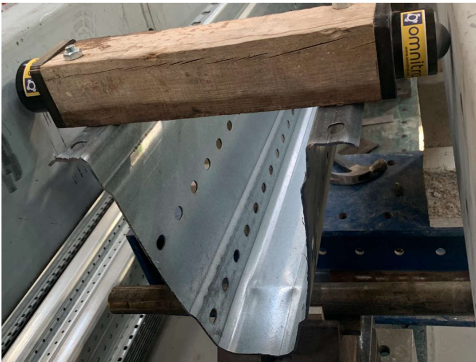
Figura A.2 – Deformação Local do Banzo do Perfil 300
