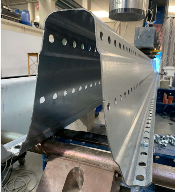
Figura A.1 – Perda de Rigidez da Alma do Perfil 300
