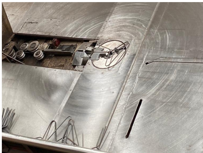
Figura 34 - Máquina de dobrar e cortar varões de aço
