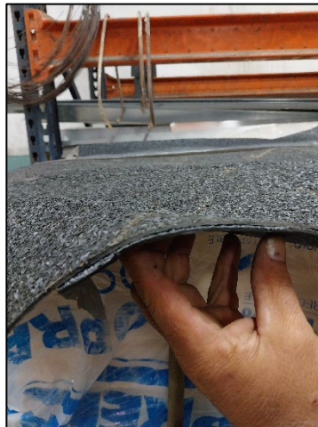
Figura 15: Membrana APP Auto Protegida, Gonçape Revestimentos Lda
