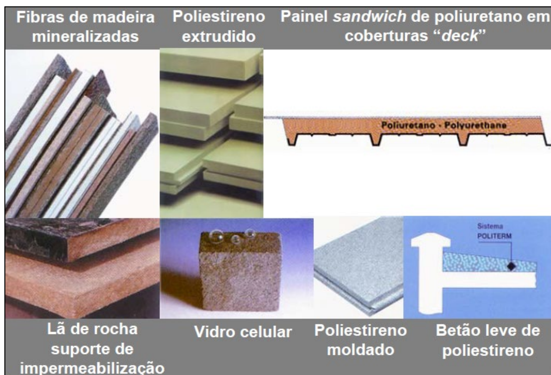
Figura 29:Sistemas de isolamento térmico: materiais [20]
