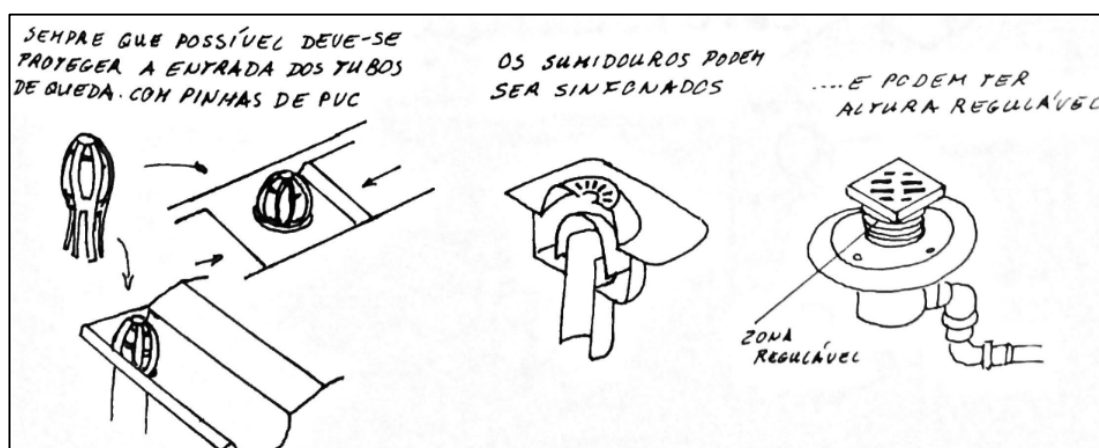
Figura 50: Acessórios presentes nas saídas de água [4]
