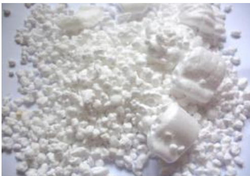
Fig.96 a) Poliestireno expandido solto [42]
