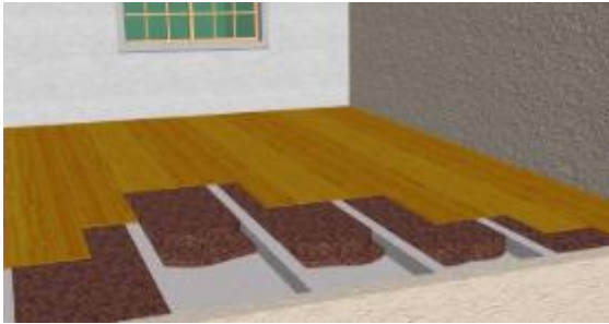
Fig.95 a) e b) – Regranulado de cortiça entre ripado de madeira [19]
