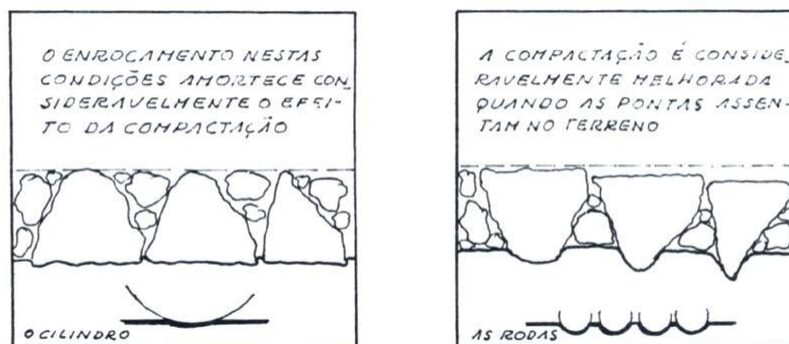
Fig.34 a) e b) – Exemplos de execução do enrocamento [6]
