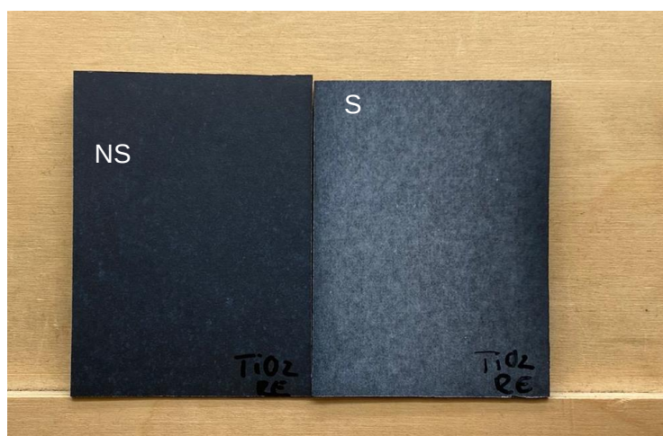
Figura 48- Resultado amostra \text{TiO}_2 : Ensaio da resistência à intempérie artificial
