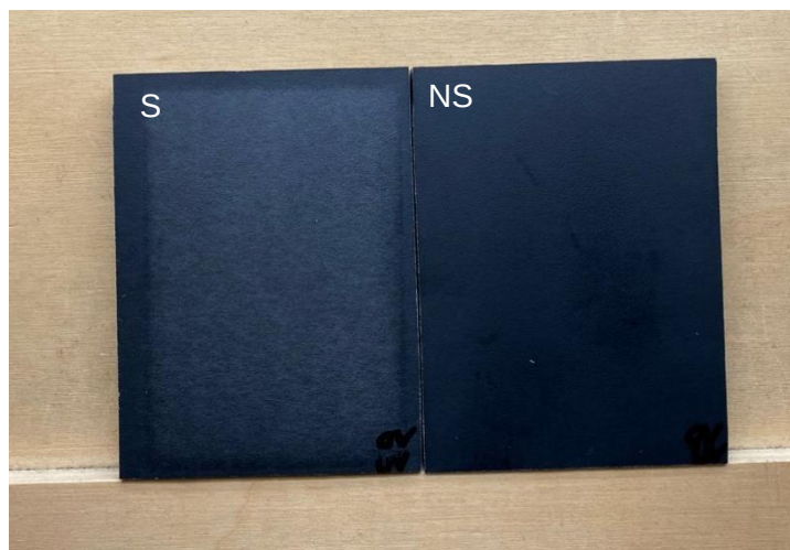
Figura 41- Resultado amostra REF: Ensaio da resistência à luz UV
