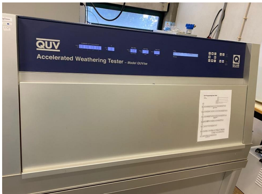
Figura 24- Câmara Climática fechada: Ensaio da resistência à luz UV
