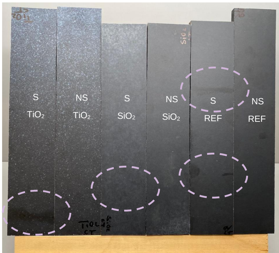
Figura 53- Resultados: Após ensaio da resistência ao choque térmico
