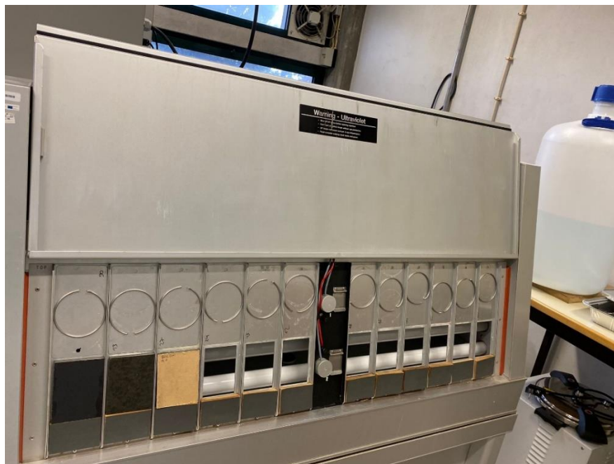
Figura 25- Câmara Climática aberta: Ensaio da resistência à luz UV
