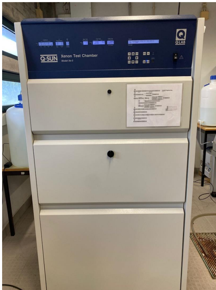
Figura 26- Câmara climática: Ensaio da resistência à intempérie artificial
