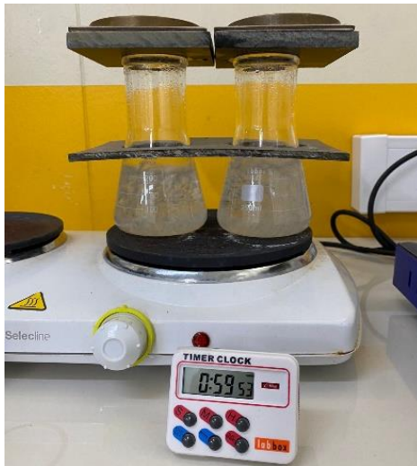
Figura 19- Equipamento: Ensaio da resistência ao vapor de água
