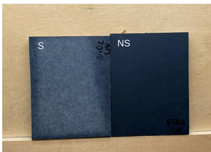
Figura 43- Resultado amostra \text{SiO}_2 : Ensaio da resistência à luz UV
