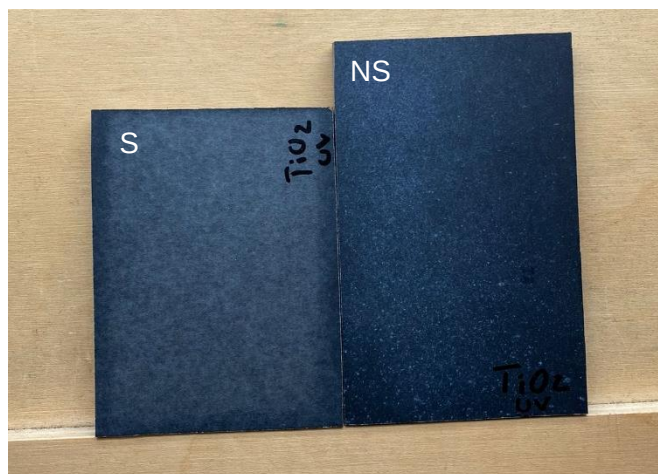
Figura 42- Resultado amostra \text{TiO}_2 : Ensaio da resistência à luz UV
