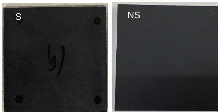
Figura 36- Resultado amostra \text{SiO}_2 : Ensaio da resistência à imersão em água em ebulição
