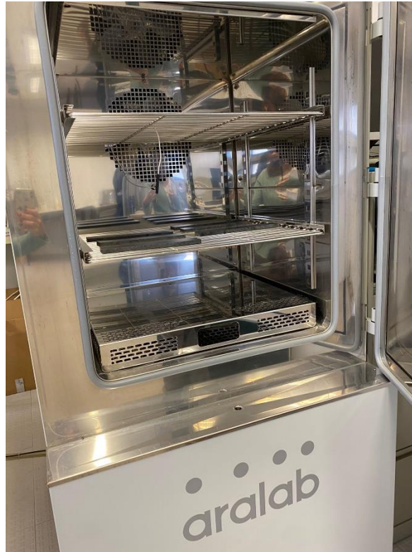
Figura 27- Câmara climática: Ensaio da resistência ao choque térmico
