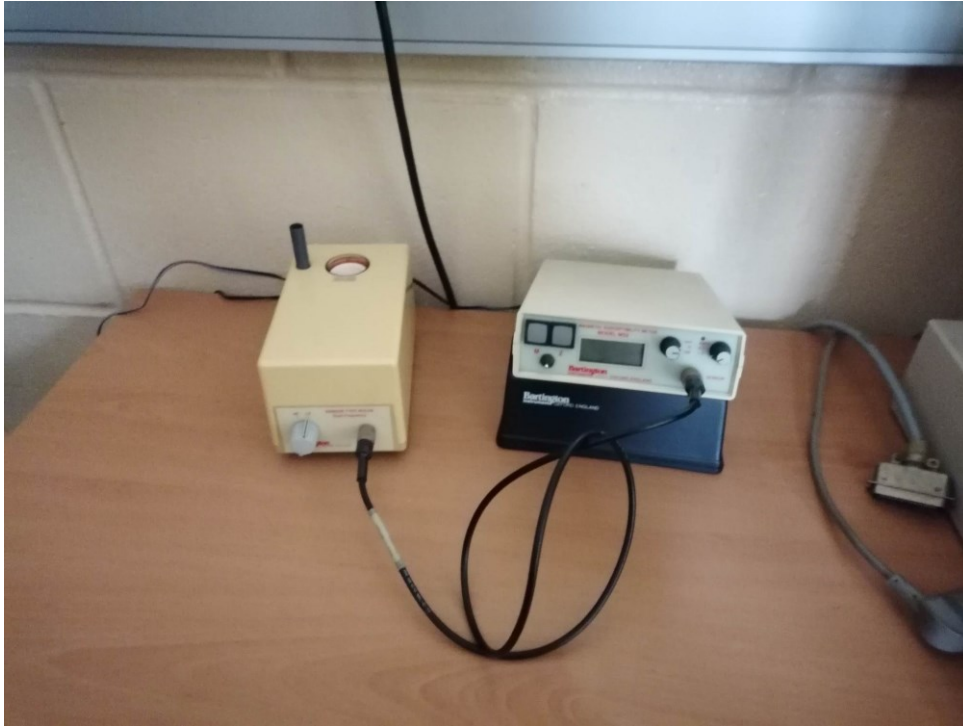
• Figura 20 – Equipamento Bartington MS2 System usado para as análises de \chi_f D .
