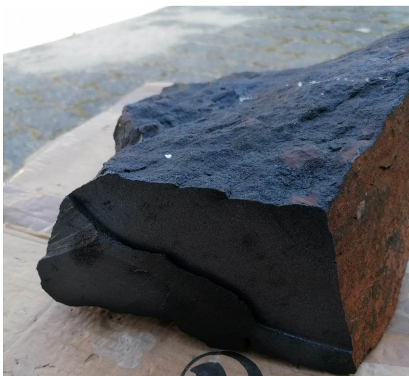
Figura 13 – Secção cortada da amostra da Carvalhosa para a elaboração de lâminas delgadas polidas.
