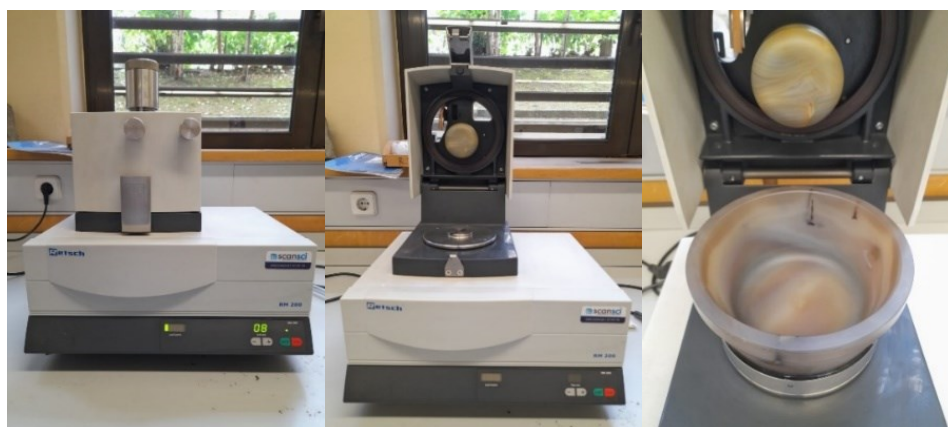
Figura 10 – Moinho de Ágata RM-200 da RETSCH (À esquerda – fechado; No centro – aberto; À direita - vista do almofariz e pilão de ágata).
