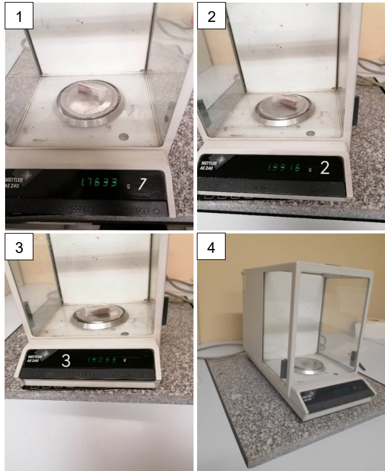
Figura 11 – Aspeto dos Eppendorfs com amostra total moída que foram enviados para as análises químicas e respetivas massas (1, 2 e 3) e aspeto da balança de precisão utilizada nas pesagens (4). 1 - Eppendorf 1 (Moncorvo_ICP); 2 - Eppendorf 2 (Moncorvo_O18); 3 - Eppendorf 3 (Moncorvo_MB); 4 – Balança digital Mettler Toledo AE240.
