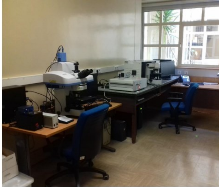
Figura 15 – Espectrómetros Raman utilizados no estudo: À esquerda, o Espectrómetro XploRATM; À direita, o Espectrómetro LabRAM.
