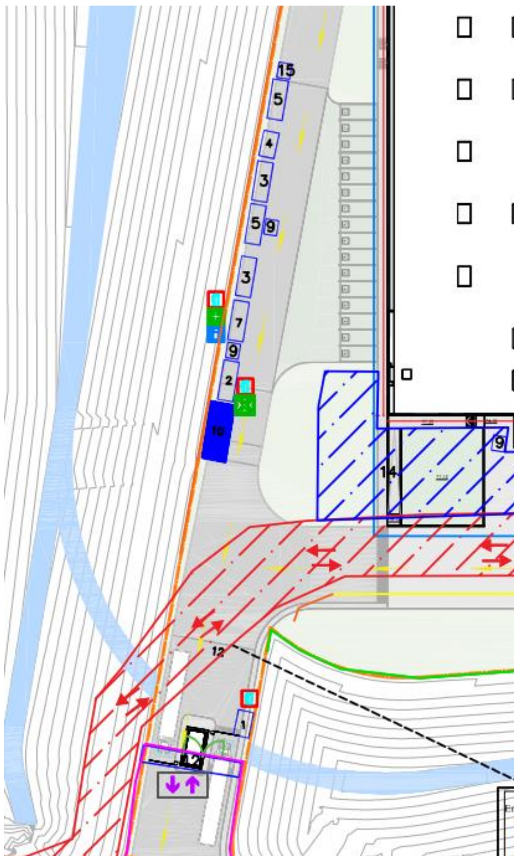
Figura 4.6 - Planta de estaleiro
