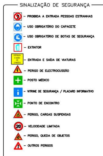
Figura 4.7 - Sinalização de segurança
