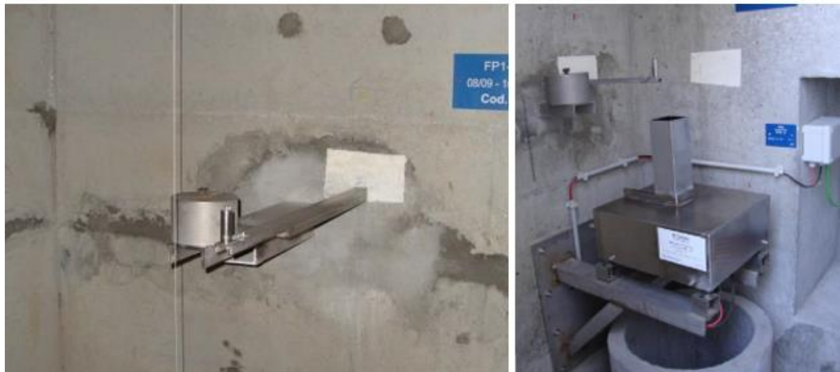
Figura 10 - Base de coordinómetro do fio de prumo (figura à esquerda) e telecoordinómetro (figura à direita), retirado de (LNEC, 2020).
