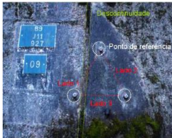
Figura 12 - Base de alônametro para medição manual, retirado de (Martins et al , 2017).
