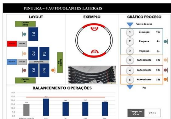
Figura 25- Ferramenta física cada referência, com as respetivas tarefas normalizadas, layout das linhas e balanceamento das operações (Yamazumi)
