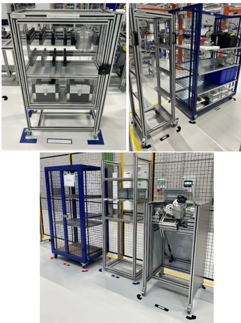
Figura G.1: Marcações do chão de fábrica
