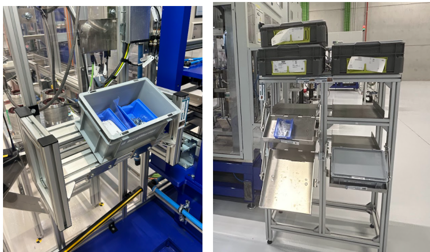
Figura B.2: Bordos de linha desadequados
