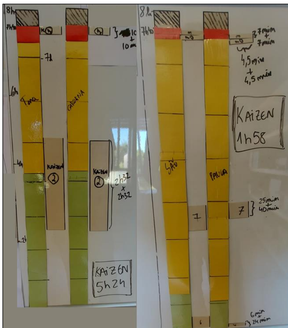
Figura 25- Yamazumi do processo de escolha e corte, respectivamente
