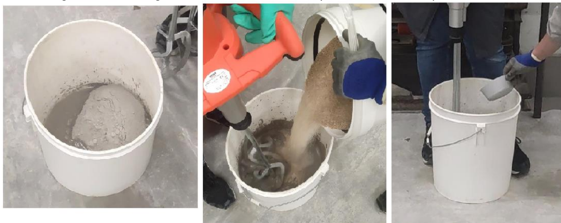
Figura 3.41 – Pesagens de cimento, areia e fibras para o fabrico de um provete cilíndrico
