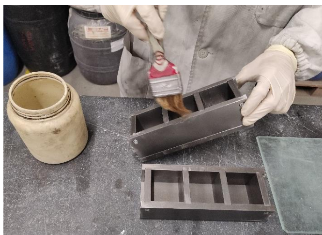
Figura 3.23 – Aplicação de óleo descofrante nos moldes cúbicos utilizados para moldar as pastas
