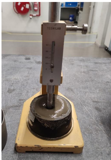
Figura 3.31 – Leitura da profundidade de penetração da sonda durante o ensaio dos tempos de presa
