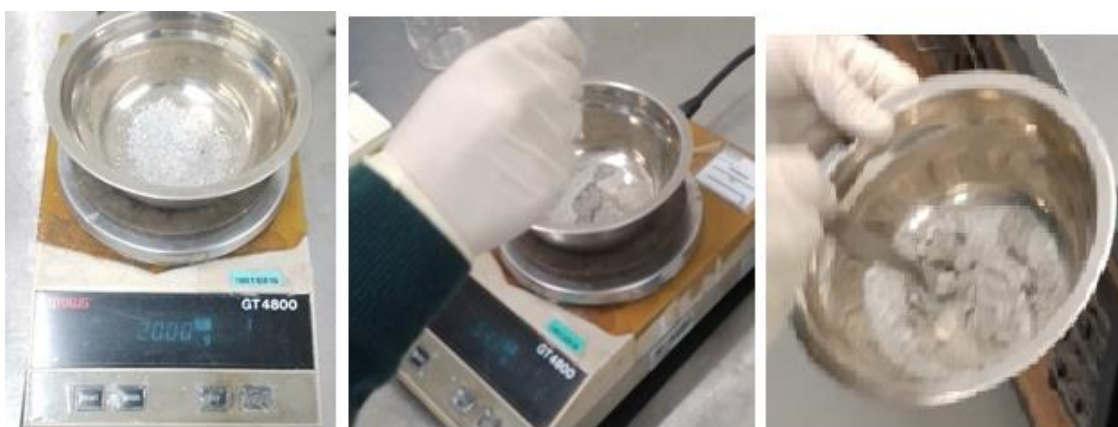
Figura 3.19 – Ensaios prévios para determinação da relação A/C das pastas
