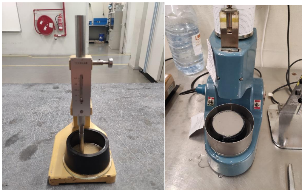
Figura 3.28 – Aparelho de Vicat para determinação de início e fim de tempo de presa
