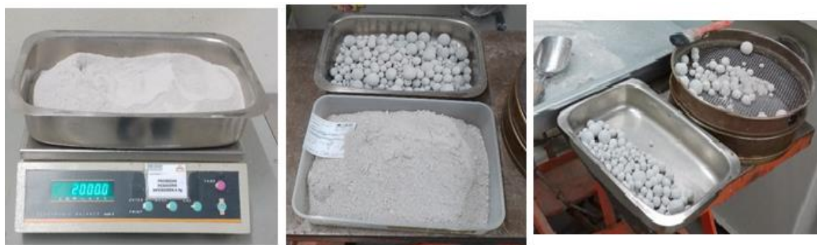
Figura 3.7 – Etapas de processo de moagem e armazenamento da escória
