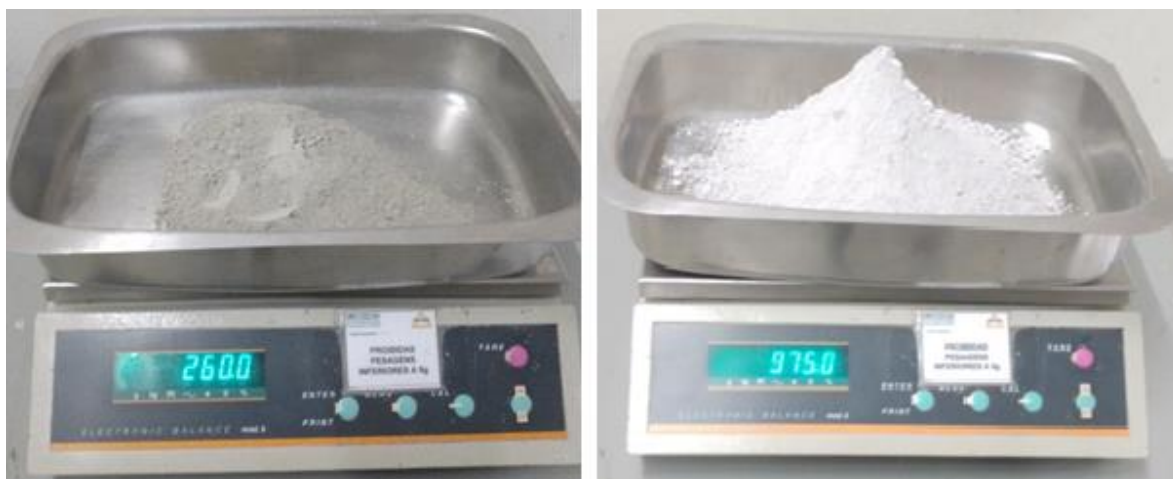
Figura 3.16 – Pesagem de cimento e da escória para processo de homogeneização
