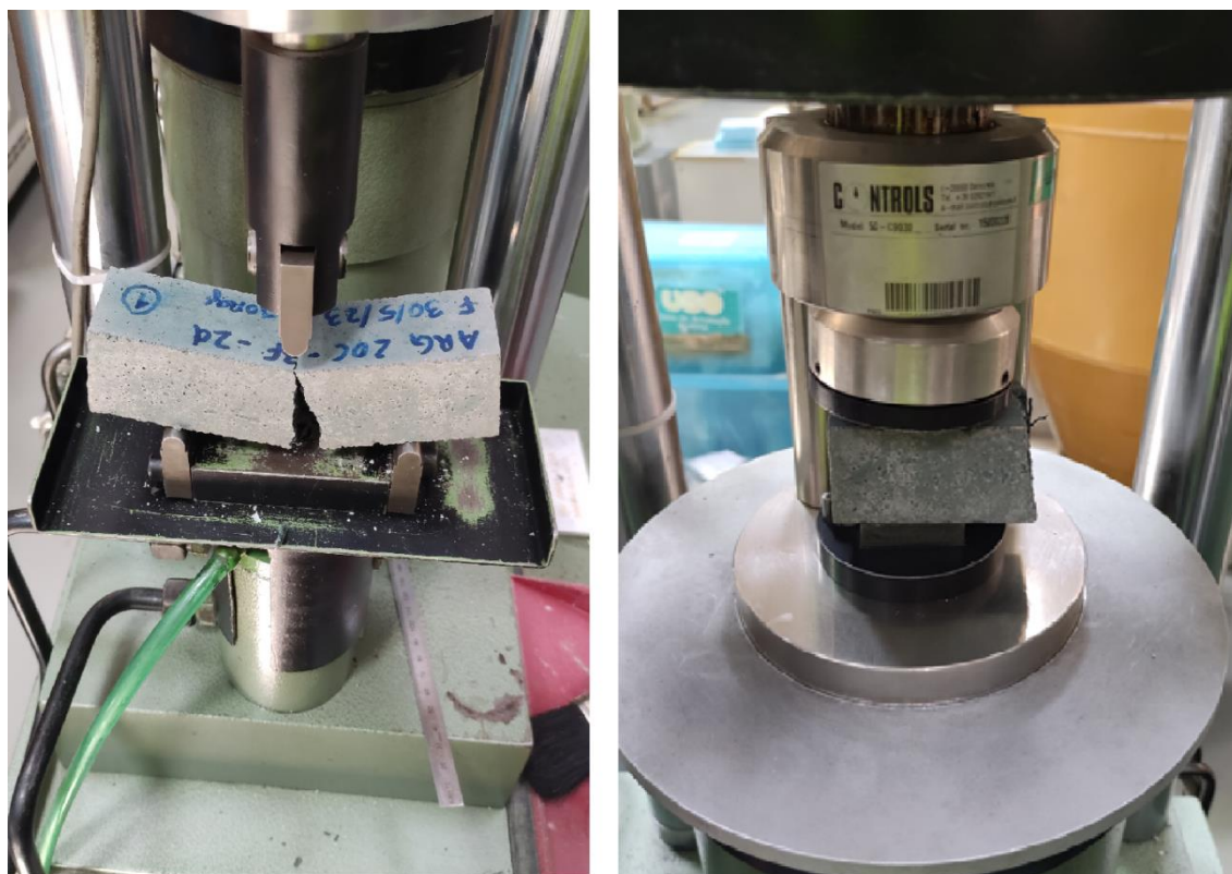
Figura 3.46 – Ensaio de resistência a flexão e a compressão de argamassas
