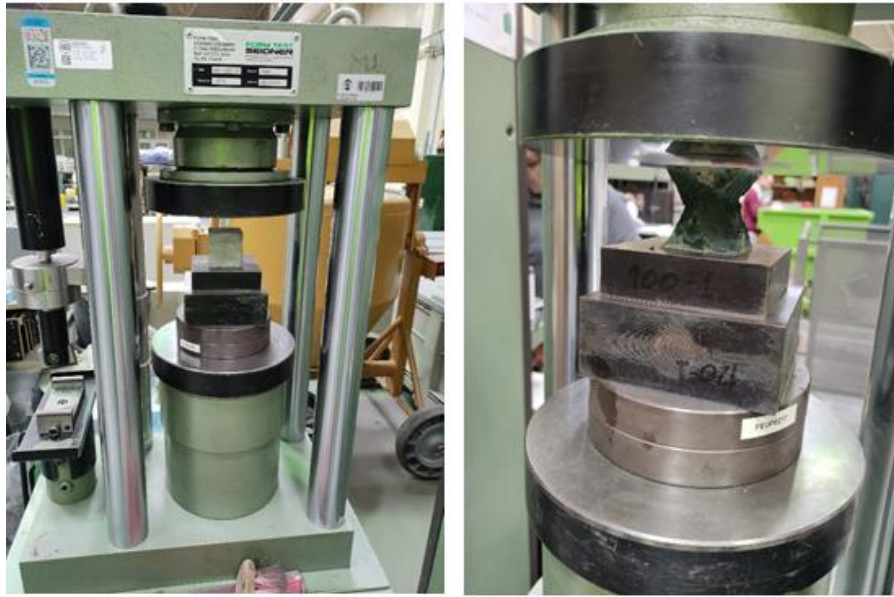
Figura 3.34 – Ensaios de resistência à compressão das pastas
