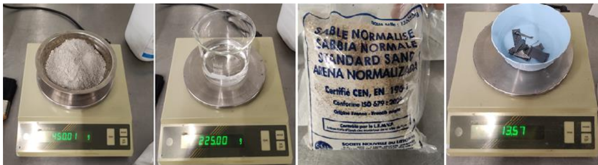
Figura 3.35 – Materiais utilizados no fabrico das argamassas (cimento, água, areia e fibras metálicas)
