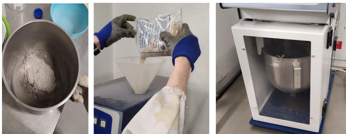
Figura 3.37 – Balde com água e cimento, introdução de areia normalizada e visão geral da misturadora
