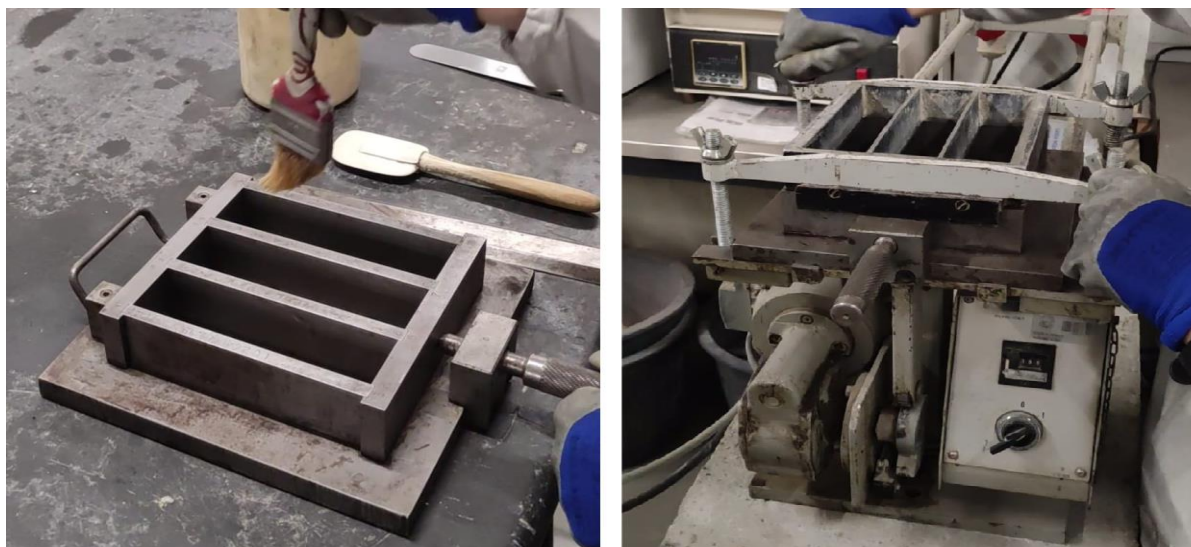
Figura 3.36 – Aplicação de óleo desmoldante nos moldes e mesa de compactação
