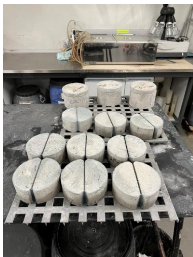
Figura 3.47 – Discos para os ensaios de tração por compressão diametral das argamassas reforçadas com fibras
