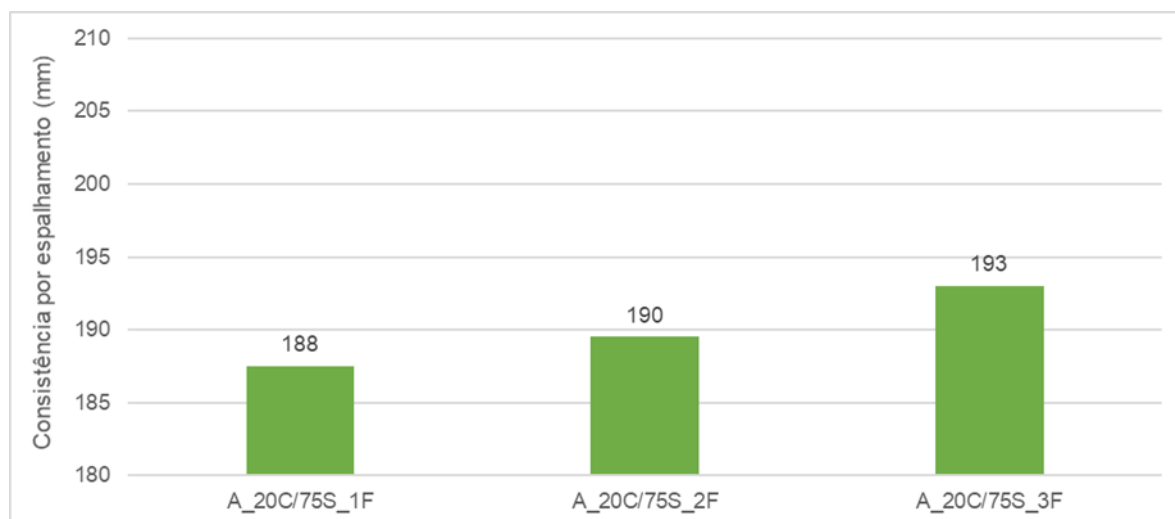
Figura 4.8 – Resultados de ensaios de consistência ao espalhamento no estado fresco de argamassas reforçadas com fibras ( Fase II)
