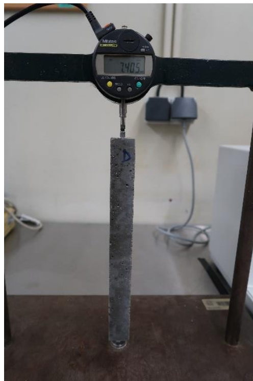
Figura 3.50 – Medição de um provete durante os ensaios de expansibilidade das argamassas
