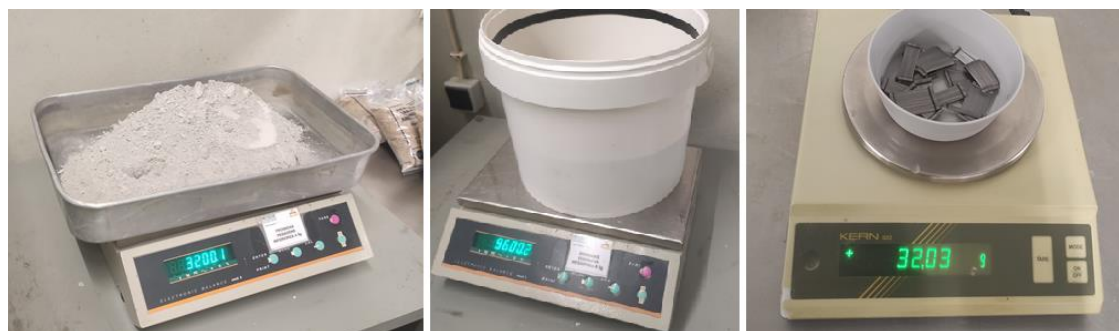
Figura 3.41 – Pesagens de cimento, areia e fibras para o fabrico de um provete cilíndrico
