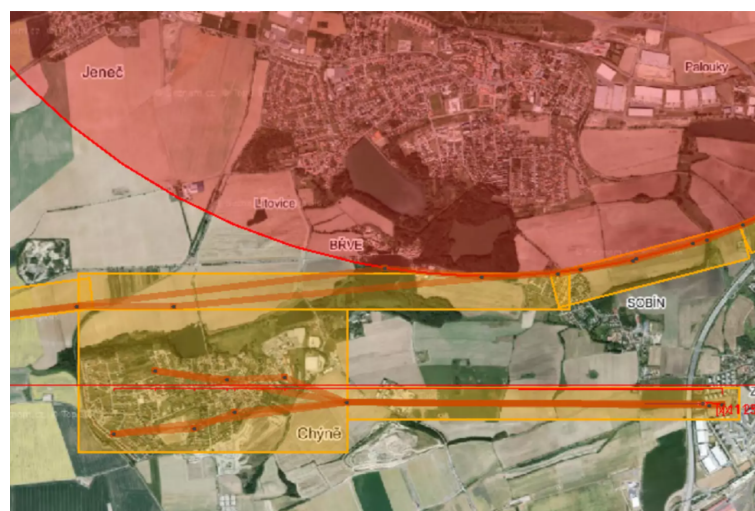
Figura 3.1: Zonas de interdição de voo num sistema para missões de entrega de mercadorias Retirado de [1]
