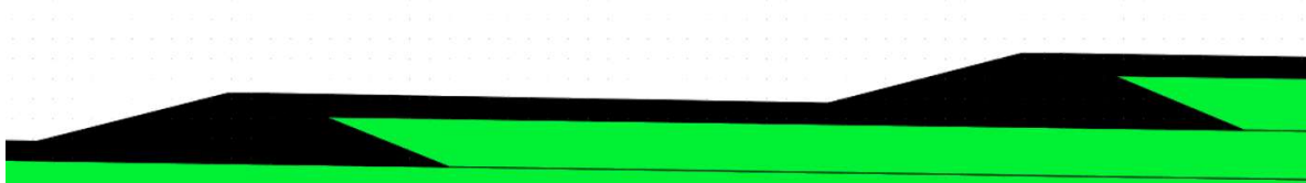
Figura 84 – Processo de Construção de Alteamentos, adaptado de modelação em PLAXIS
