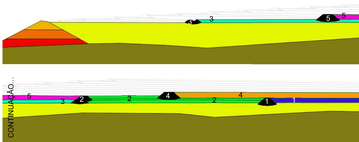
Figura 89 – Faseamento de Deposição por Células (IRCL), adaptado de desenho de modelação PLAXIS
