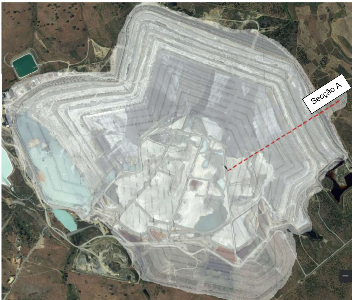
Figura 86 – Sobreposição da Planta de Encerramento da IRCL com a Imagem do Google Earth e a Secção A a Analisar
