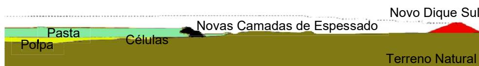
Figura 82 – Dique Sul da Fase Atual de Expansão, adaptado de desenho de modelação PLAXIS
