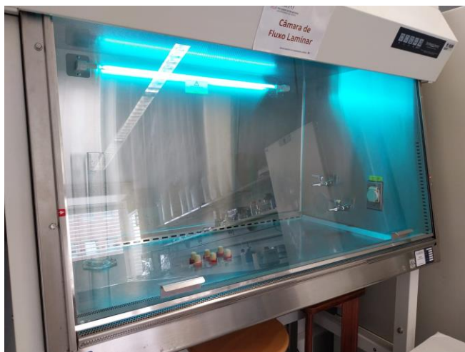
Figura B.1 - Câmara de fluxo laminar para esterilização UV
