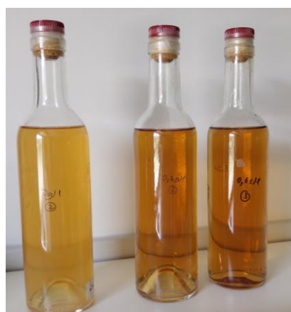
Figura 4.5 - Aspeto do simulador C, D e E, respetivamente, após duas semanas de contacto com a rolha.
