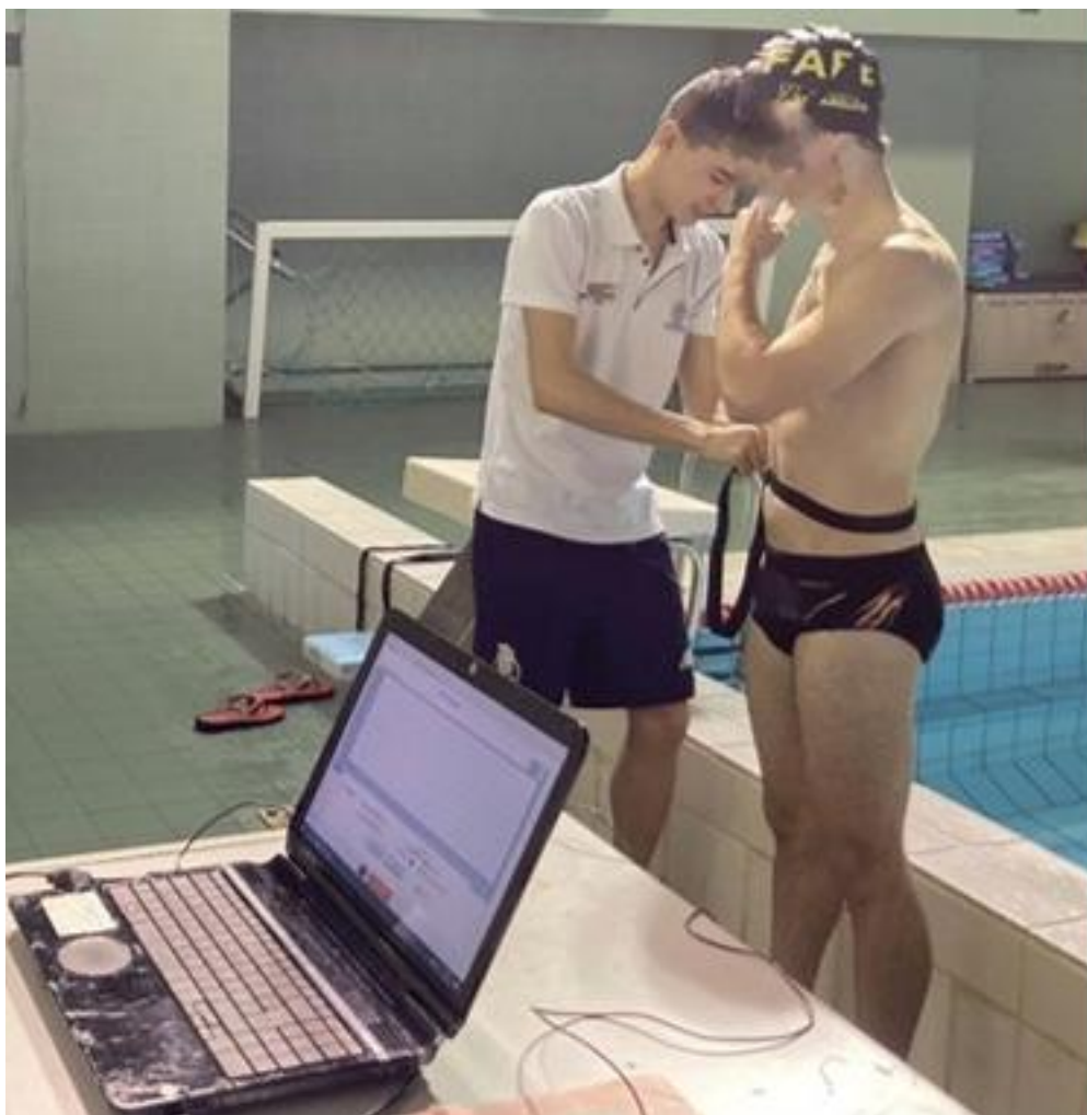
Figura 4: Colocação da cinta com fio de recolha de dados do velocímetro no nadador.
