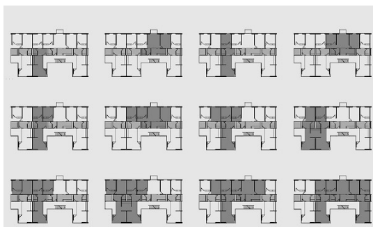
Img. 114 Planta das diferentes possibilidades de tipologias do edifício Überbauung Hellmutstrasse, arquitetos ADP Architektur und Planung, Suíça, 1991
