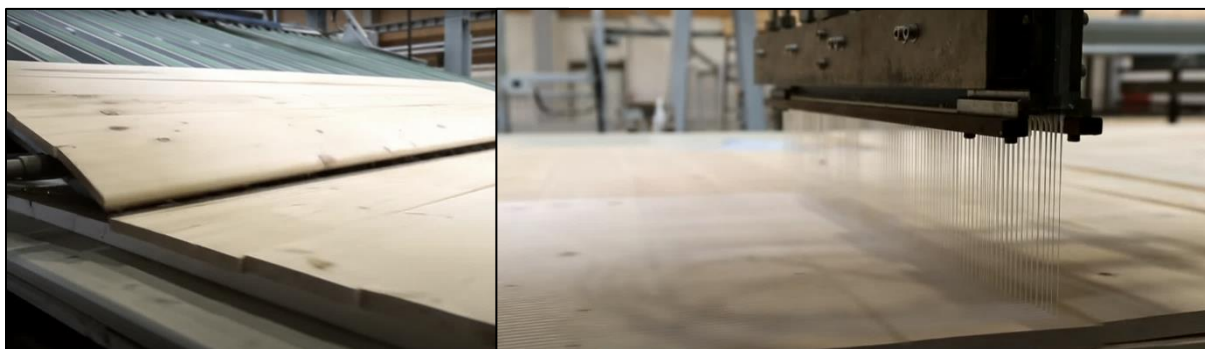
Fig. 2.6 – Disposição das lamelas lado a lado e colagem [9]
