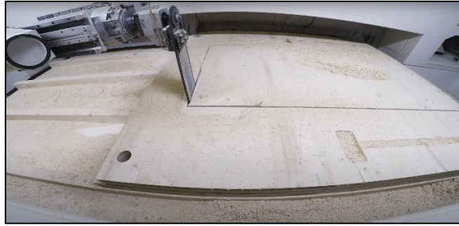
Fig. 2.8 – Corte através de controlo numérico computadorizado (CNC) [9]
