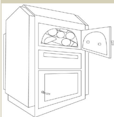
Figura 33 – Sistema de caldeira de gaseificação de biomassa
