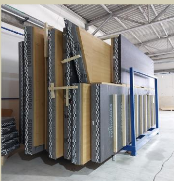
Figura 45 – Acondicionamento dos painéis em berço
