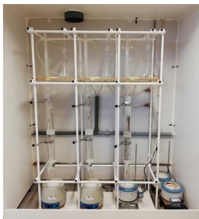
Figura 4.18 – Perforadores utilizados para a determinação do teor de formaldeído
