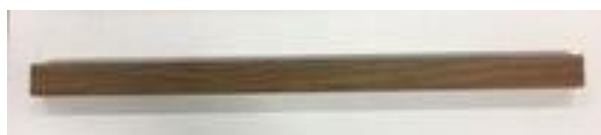
Figura 4.22 – Amostra de Thermowood, madeira modificada submetida a ensaio.
