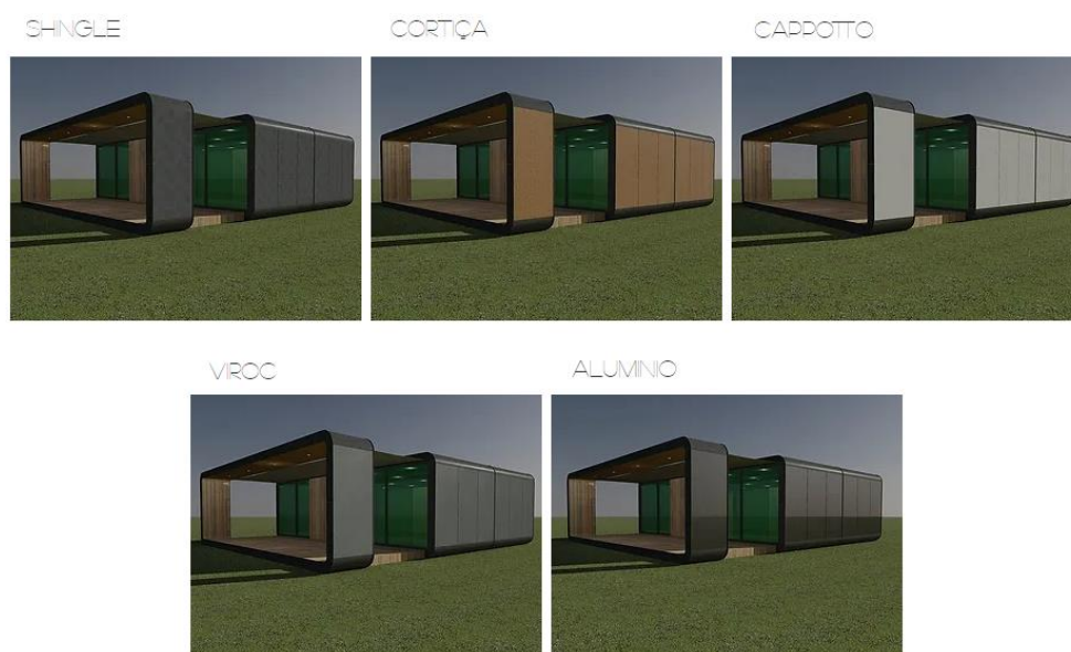
Figura 2.21 – Outras opções de revestimento exterior [22]
