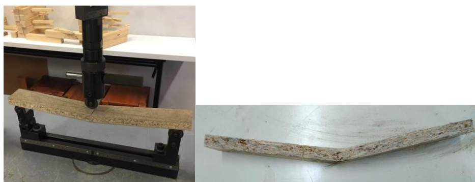
Figura 4.10 – Ensaio de determinação do módulo de elasticidade em flexão e da resistência à flexão
