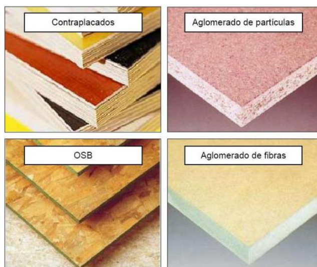
Figura 2.2 – Exemplos de derivados da madeira [8]
