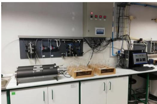
Figura 4.19 – Câmaras e frascos de recolha utilizados no método da análise do gás
