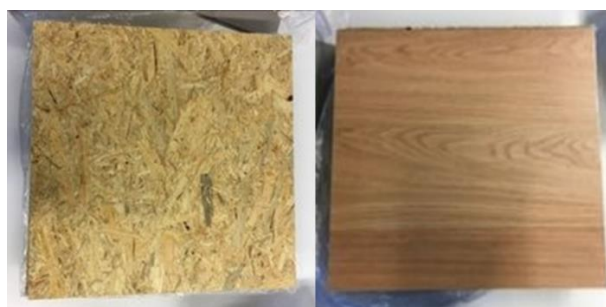
Figura 4.21 – Amostras de materiais de construção para aplicação no interior/exterior; esquerda – OSB, direita – Pavimento flutuante
