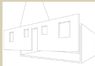
Figura 51 – Assemblagem de painéis verticais
