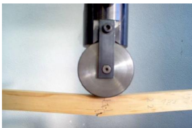
Figura 4.11 – Ensaio de flexão a 3 pontos de Thermowood®
