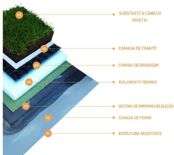
Figura 3.13 – Constituição da cobertura verde [58]
