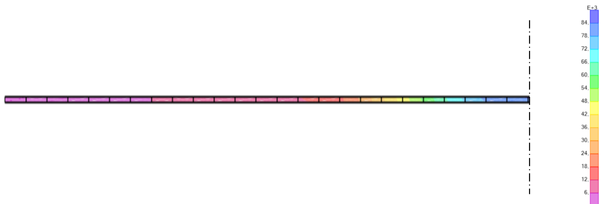
Figura 33 – Mapa de tensões S11 na resina
