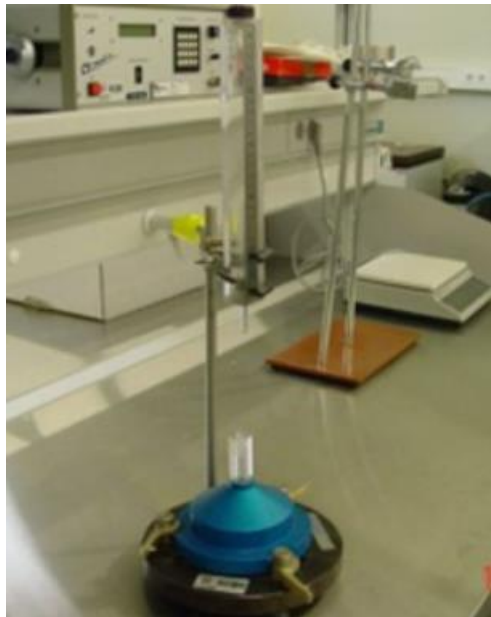
Figura 14 – Equipamento de determinação da permeabilidade em provetes de reboco segundo Cashier [26].
