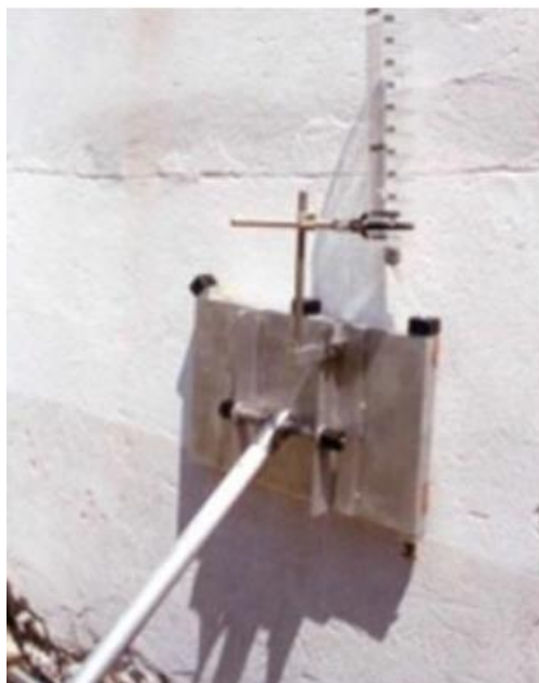
Figura 16 – Equipamento de permeabilidade de paredes in situ [26].
