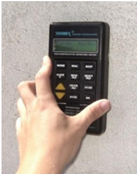
Figura 13 – Aparelho do ensaio de teor de humidade [25].
