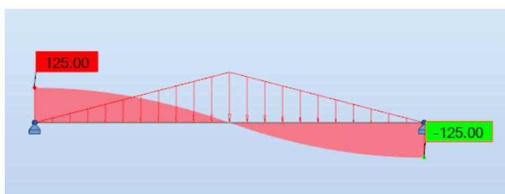
Figura 13 - Esforço transversor de referência nas vigas de contorno
