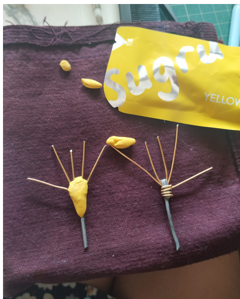
Imagem 61 e 62 | Primeira experiência de mãos, à esquerda apenas com arame de alumínio e Sugru , e à direita o uso de estanho para o pulso, com a intenção de o soldar à peça de união ao braço.
