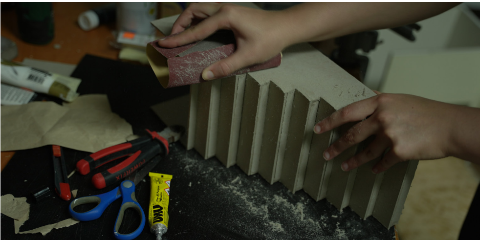
Imagem 109 | Execução da escada recorrendo a longarinas.
