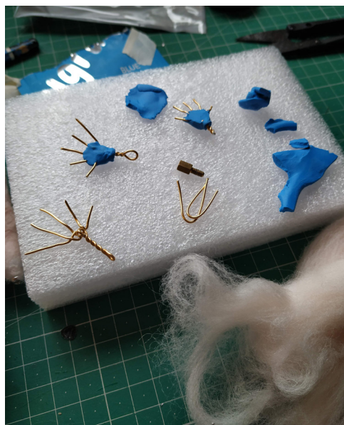
Imagem 61 e 62 | Primeira experiência de mãos, à esquerda apenas com arame de alumínio e Sugru , e à direita o uso de estanho para o pulso, com a intenção de o soldar à peça de união ao braço.
