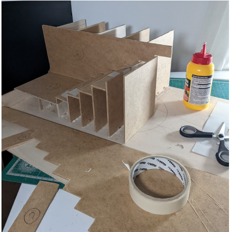
Imagem 74 e 75 | Início da construção da escada exterior, note-se a estrutura em MDF. À direita o início do processo de forrar a estrutura a cartão prensado de 2mm.
